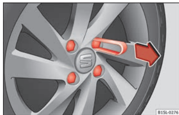
Obr. 51 Stáhnutí krytek ze šroubů kola
