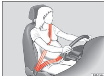
Obr. 71 Průběh bezpečnostního pásu u těhotné ženy.
