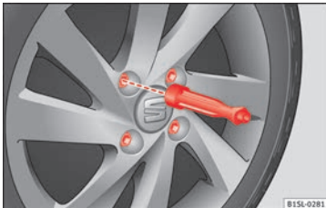
Obr. 56 Výměna kola: našroubování šroubů kol rukojetí šroubováku.
