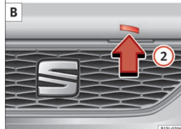
Obr. 8 A: Uvolňovací páčka v prostoru nohou na straně řidiče; B: Uvolňovací páčka na víku motorového prostoru.
