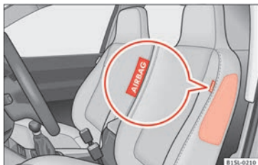
Obr. 21 Na straně předního sedadla: umístění bočního airbagu.
