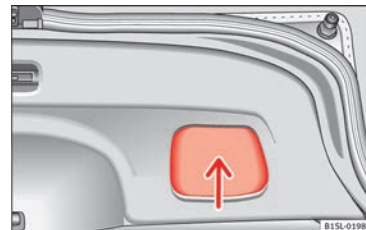
Obr. 6 Otevřená zadní výklopná dveře: zapažené madlo pro zavírání zavazadlového prostoru
