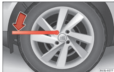
Obr. 52 Výměna kola: povolte šrouby kol.
