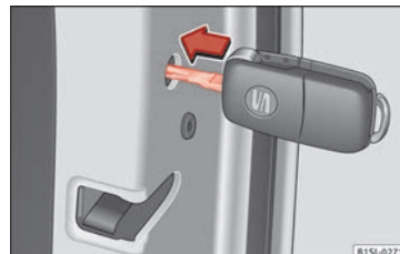
Obr. 5 Nouzové zamykání vozidla klíčem vozidla.
