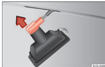
Obr. 89 Světlo registrační značky: Demontáž nosiče žárovky.
