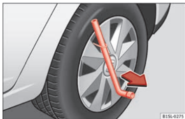
Obr. 50 Stáhnutí celoplošného krytu kola.
