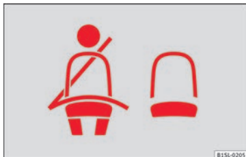
Obr. 66 Ukazatel stavu bezpečnostního pásu u zadních sedadel na displeji panelu přístrojů.
