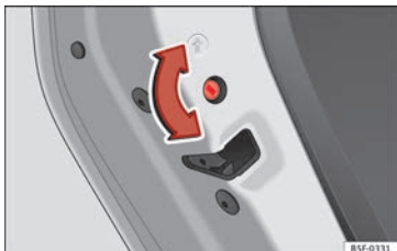
Obr. 103 Bezpečnostní dětská pojistka v levých dveřích
