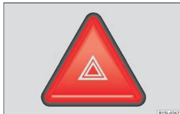
Obr. 108 Přístrojová deska: Tlačítko zapínání a vypínání varovných světel.
