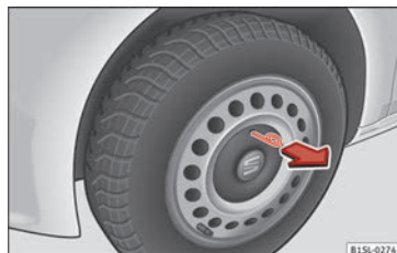
Obr. 49 Stáhněte středový kryt z ocelového disku.
