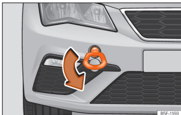
Obr. 48 Přední nárazník vpravo: zašroubované vlečné oko.
