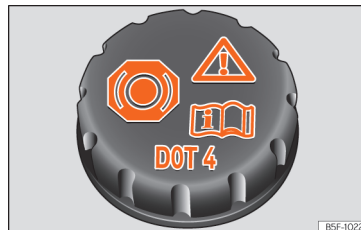
Obř. 321 Motorový prostor: uzávěr nádobky brzdové kapaliny.
