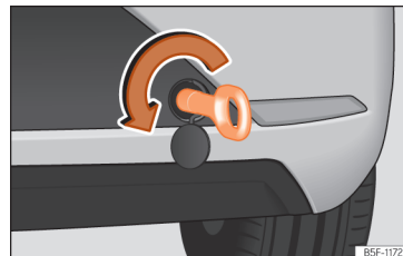
Obr. 50 Zadní nárazník vpravo: zašroubované vlečné oko.
