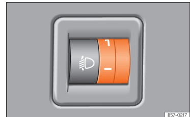
Obr. 118 Vedle volantu: Ovladač regulace dosahu světel.
