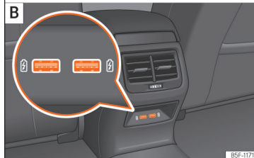
Obr. 167 A | Středová konzola: zásuvka 12V vpředu. B | Zadní strana středové konzole: zásuvky USB.
