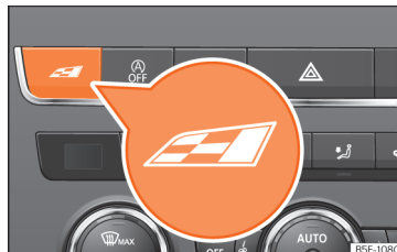
Obr. 265 Středová konzola: Tlačítko profilu Cupra Drive. Můžete volit mezi profily Komfort, Sport, Cupra a Individual.
