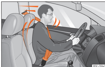
Obr. 7 Řidiči se správně připnutými pásy nebudou při náhlém brzdění vymrštěni dopředu.
