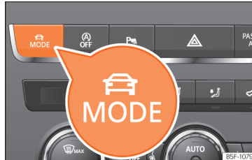
Obr. 264 Středová konzola: tlačítko MODE. Můžete volit mezi režimy Normal, Sport, Eco, Komfort a Individual.
