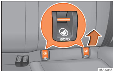
Obr. 28 Zadní sedadlo: Přídržná oka ISOFIX
