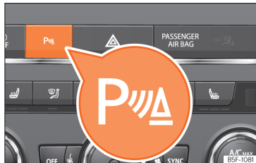
Obr. 291 Středová konzola: Tlačítko parkovacího asistenta.
