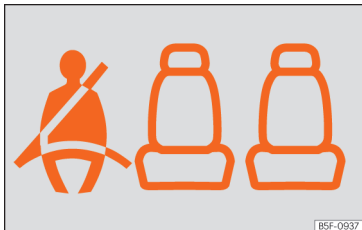
Obr. 6 Panel přístrojů: Zobrazení, že místo vazu vlevo je obsazeno a spolucestující má připnutý bezpečnostní pás.
