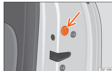
Obr. 103 Nouzová uzávěra dveří.
