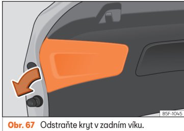
Obr. 67 Odstraňte kryt v zadním víku.
