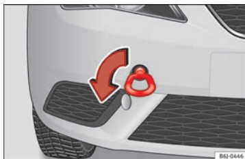
Obr. 68 Přední nárazník vpravo: Vlečné oko.
