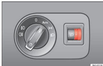
Obr. 135 V přístrojové desce: Ovladač nastavení sklonu světlometů.
