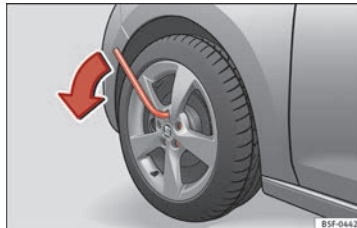
Obr. 65 Kolo: povolte šrouby kol.
