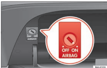
Obr. 19 Spínač čelního airbagu spolujezdce.
