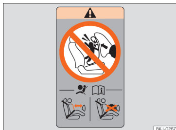
Obr. 39 Štítek airbagu: na horním rámu dveří spolujezdce.
