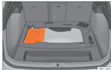
Obr. 235 Plug-in hybridní vozidla (PHEV): montážní místo akumulátoru v zavazadlovém prostoru
