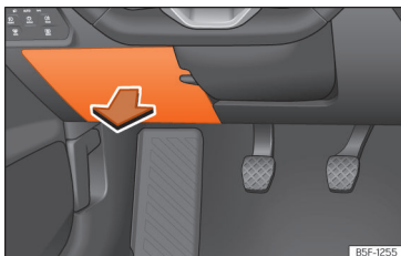
Obr. 220 Na straně řidiče v přístrojové desce: kryt pojistkové skříňky.
