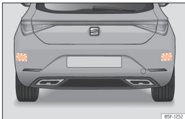
Obr. 130 Oblast za vozidlem: oblasti radarových snímačů.
