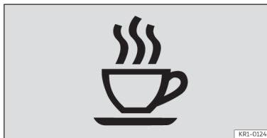
Obr. 7 Na displeji panelu přístrojů: symbol monitoru únavy.
