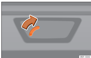
Obr. 85 Detail zavazadlového prostoru: nouzové odemýkání (Leon Sportstourer).
