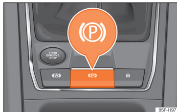
Obr. 151 Ve spodní oblasti středové konzoly: tlačítko elektronické parkovací brzdy.
