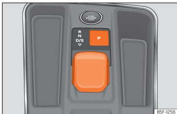
Obr. 124 Ve středové konzole: Volicí spínač
