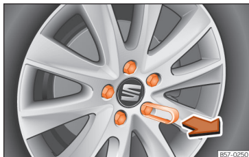
Obr. 244 Kolo: šrouby kola s víkem.
