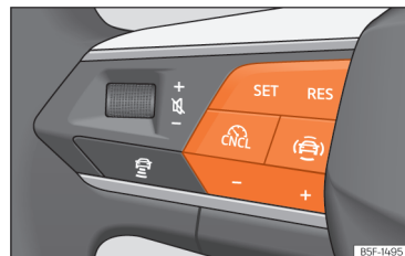
Obr. 133 Na multifunkčním volantu: tlačítka k ovládání tempomatu.
