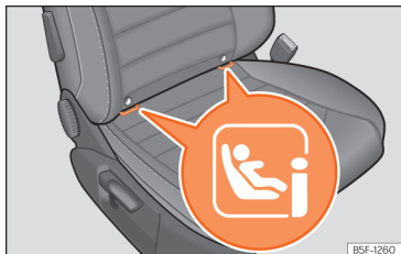
Obr. 41 Sedadlo spolujezdce: Montážní místo přídržného oka pro i-Size.
