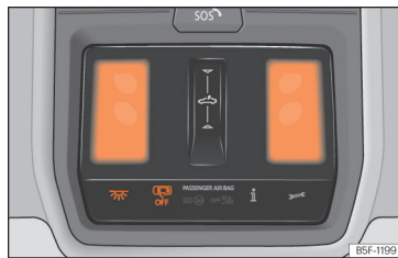
Obr. 106 Výřez stropního panelu: vnitřní osvětlení vpředu.
