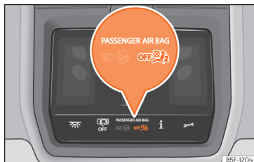
Obr. 29 Ve stropní konzole: kontrolka odpojení airbagu na straně spolujezdce.
