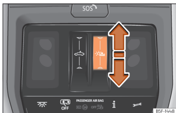
Obr. 89 Ve stropním panelu: ovládání protisluneční rolety.
