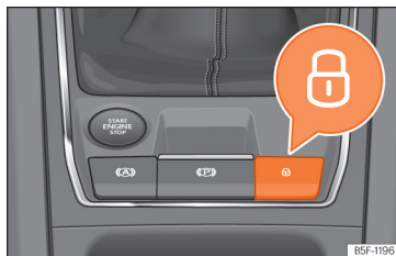
Obr. 76 Na středové konzole: Tlačítko centrálního zamykání
