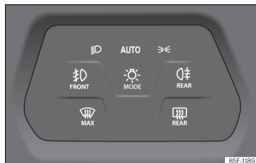
Obr. 104 Přístrojová deska: spínač světel.
