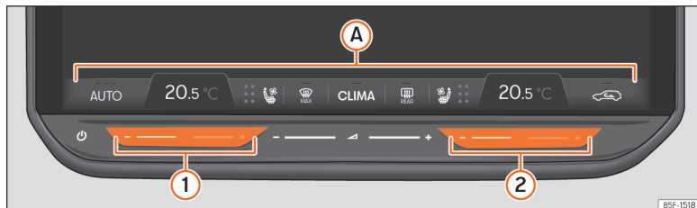
Obr. 114 Schématické znázornění: funkce klimatizace.
