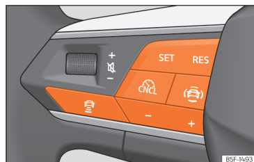
Obr. 137 Na multifunkčním volantu: tlačítka k ovládání systému ACC.
