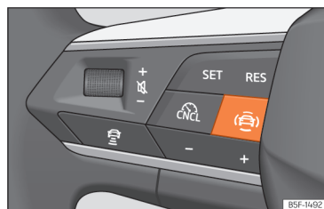
Obr. 126 Levá strana multifunkčního volantu: tlačítko asistenčních systémů řidiče (v závislosti na modelu).
