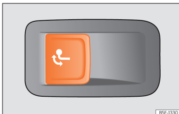
Obr. 201 Na levé straně v zavazadlovém prostoru: tlačítko k odjištění kulové hlavy.
