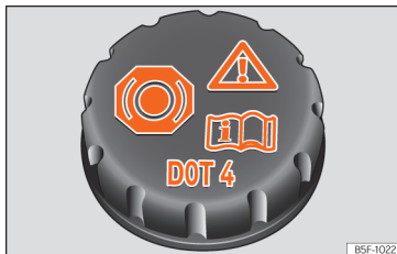
Obr. 228 Motorový prostor: uzávěr nádržky brzdové kapaliny
