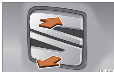
Obr. 80 Zadní víko: otvírání zvenku
