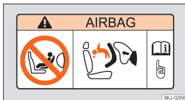
Obr. 38 Štítek airbagu: na sluneční cloně.
