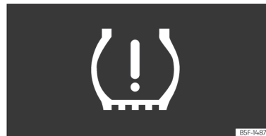
Obr. 250 Sdružené přístroje: výstraha pro ztrátu tlaku v pneumatice.
