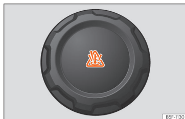
Obr. 227 Přední prostor: uzávěr vyrovnávací nádobky chladicí kapaliny.
