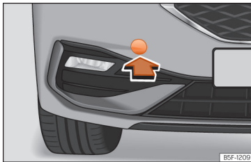
Obr. 216 Na pravé straně předního nárazníku: odstranění krytu.
