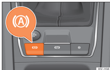
Obr. 152 Ve spodní oblasti středové konzoly: tlačítko funkce Auto Hold.
