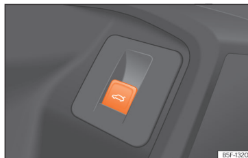
Obr. 82 Na dveřích řidiče: tlačítko pro otvírání a zavírání zadního víka.
