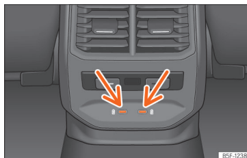
Obr. 169 Středová konzola vzadu: Přípojky USB s funkcí zásuvky.
