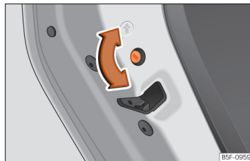
Obr. 79 Dětská pojistka v levých dveřích.
