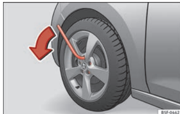
Obr. 73 Kolo: povolte šrouby kol.
