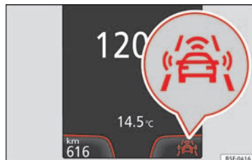
Obr. 204 Na displeji panelu přístrojů: zobrazení, že Front Assist je vypnutý.
