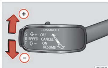
Obr. 197 Na levé straně sloupku řízení: třetí páčka pro ovládání automatické regulace odstupu.
