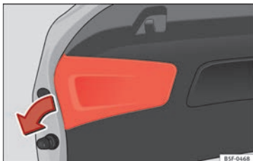
Obr. 118 Odstranění krytu ve víku zavazadlového prostoru
