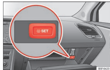
Obr. 241 Odkládací přihrádka: Spínač ukazatele kontroly pneumatik.
