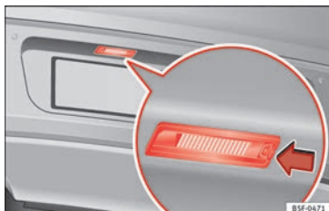
Obr. 121 Zadní nárazník: Osvětlení státní poznávací značky.
