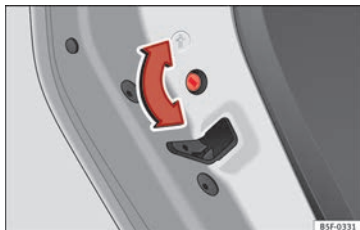
Obr. 135 Bezpečnostní dětská pojistka v levých dveřích
