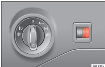
Obr. 140 Vedle volantu: Ovladač regulace sklonu světlometů.
