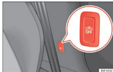
Obr. 136 Tlačítko systému sledování vnitřního prostoru/hlídkání ochrany proti odtazeni
