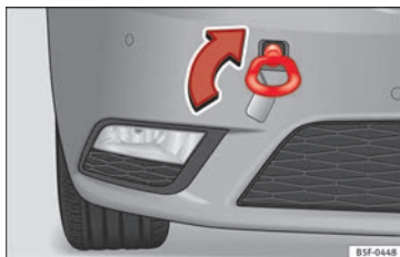
Obr. 98 Přední nárazník vpravo: zašroubované vlečné oko
