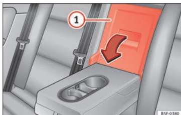
Obr. 170 Na opěradle zadního sedadla: otvor průchozího úložného zařízení.
