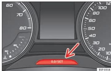
Obr. 125 Panel přístrojů: Počítadlo kilometrů a nulovací tlačítko.
