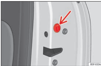
Obr. 4 Nouzové zablokování dveří.
