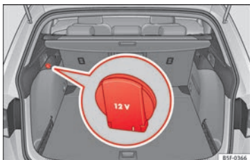
Obr. 158 Detail u bočního vnitřního obložení zavazadlového prostoru: 12 V zásuvka (platí pouze pro model LEON ST).
