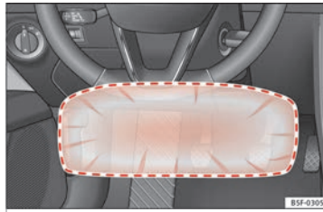
Obr. 25 Na straně řidiče: oblast účinnosti kolenního airbagu.
