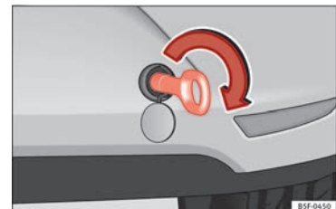
Obr. 77 Zadní nárazník vpravo: zašroubované vlečné oko
