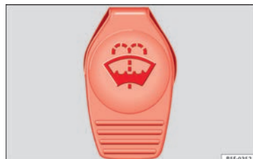
Obr. 64 V motorovém prostoru: uzávěr nádrčky kapaliny do ostřikovačů.
