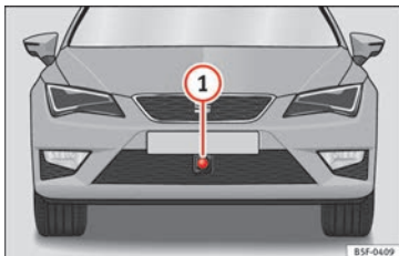
Obr. 195 V předním nárazníku: radarový snímač.
