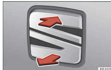
Obr. 5 Víko zavazadlového prostoru: otevření zvenku
