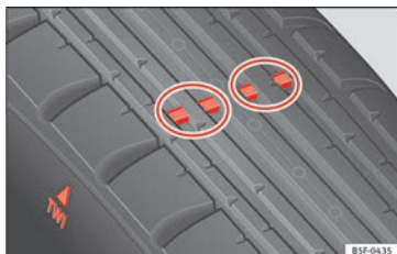
Obr. 238 Vzorek pneumatiky: ukazatele opotřebení.
