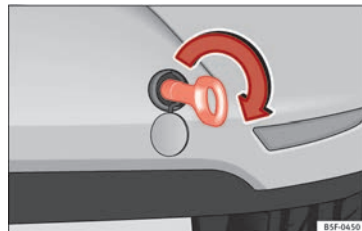
Obr. 100 Zadní nárazník vpravo: zašroubované vlečné oko
