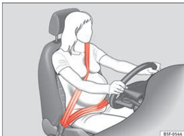
Obr. 93 Průběh bezpečnostního pásu u těhotné ženy.
