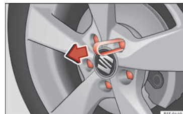
Obr. 71 Kolo: Šrouby kola s víkem.
