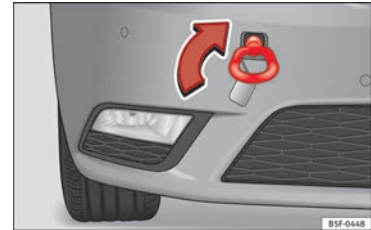
Obr. 76 Přední nárazník vpravo: zašroubované vlečné oko
