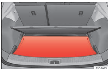
Obr. 163 V zavazadlovém prostoru: Nasazení krytu zavazadlového prostoru.
