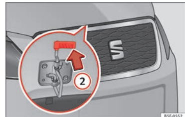
Obr. 9 Páčka pod víkem motorového prostoru.
