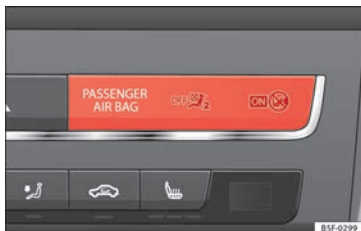
Obr. 96 Kontrolka deaktivace airbagu spolujezdce.
