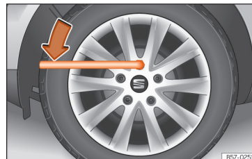
Obr. 37 Výměna kola: povolení šroubů kola.
