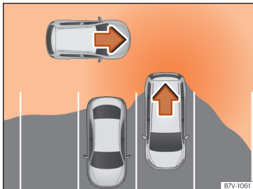
Obr. 244 Schematické zobrazení asistenta vyparkování: kontrolovaná oblast vyjíždění vozidla.
