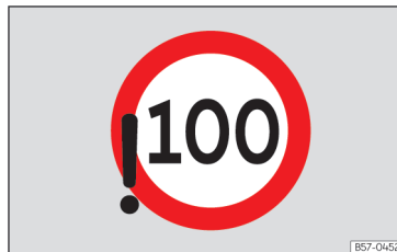
Obr. 9 Na displeji panelu přístrojů: zjištění překročení přípustné maximální rychlosti (vyobrazení).
