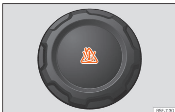
Obr. 172 Přední prostor: uzávěr vyrovnávací nádobky chladicí kapaliny.
