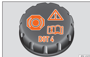
Obr. 173 Motorový prostor: uzávěr nádrčky brzdové kapaliny
