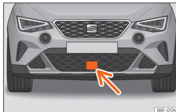
Obr. 95 V předním nárazníku: radarový snímač.
