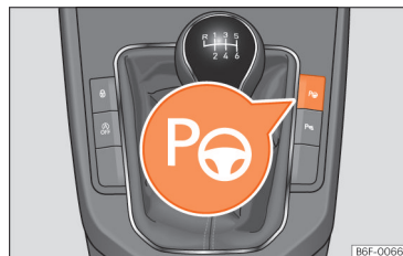
Obr. 123 Ve středové konzole: tlačítko pro zapnutí naváděcího parkovacího asistenta.
