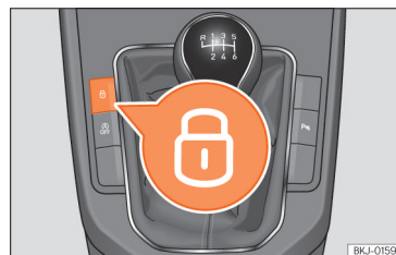
Obr. 53 Středová konzola: tlačítko centrálního zamykání.
