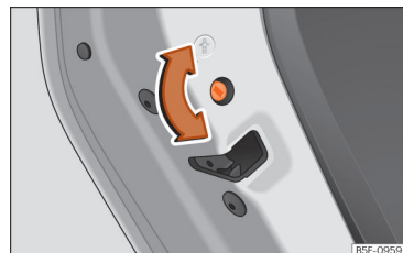
Obr. 57 Dětská pojistka v levých dveřích.
