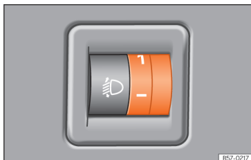
Obr. 73 Vedle volantu: ovladač regulace dosahu světel
