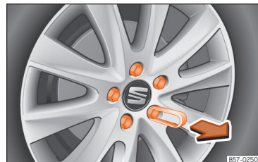
Obr. 194 Kolo: šrouby kola s víkem.
