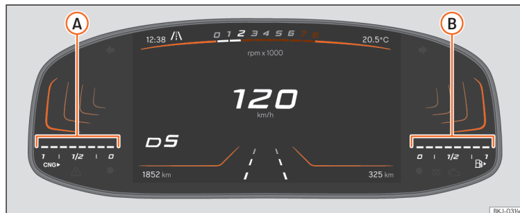
Obr. 7 Panel přístrojů: ukazatel zásoby zemního plynu
