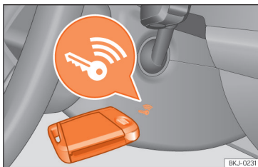
Obr. 85 Vpravo na sloupku řízení: nouzový start.
