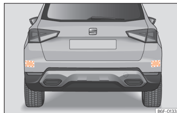
Obr. 98 Oblast za vozidlem: oblasti radarových snímačů.
