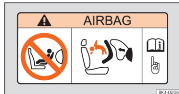
Obr. 36 Štítek airbagu: na sluneční cloně.
