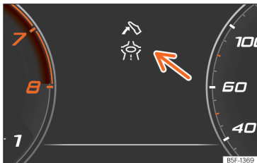
Obr. 12 Signalizace asistenta pro ekologický způsob jízdy (schématické znázornění).
