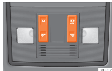
Obr. 74 Výřez stropního panelu: vnitřní osvětlení vpředu.
