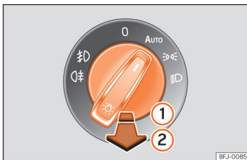
Obr. 71 Přístrojová deska: ovládací prvek světel
