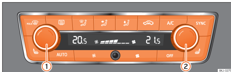
Obr. 81 Ve středové konzole: ovládací prvky pro Climatronic.
