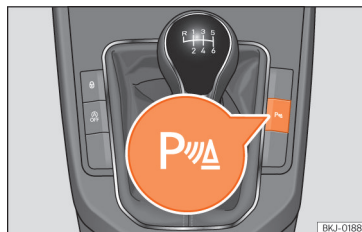
Obr. 120 Středová konzola: Tlačítko parkovacího asistenta (dle provedení).
