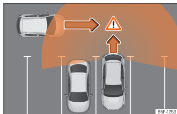
Obr. 130 Schematické vyobrazení asistenta vyparkování: sledovaná oblast vyjíždějícího vozidla.
