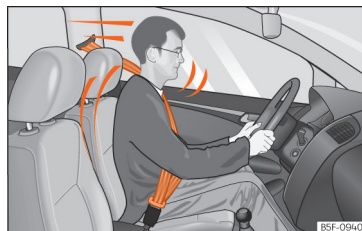
Obr. 20 Řidiči se správně připnutými pásy nebudou při náhlém brzdění vymršteni dopředu.
