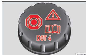
Obr. 53 Motorový prostor: uzávěr nádržky brzdové kapaliny
