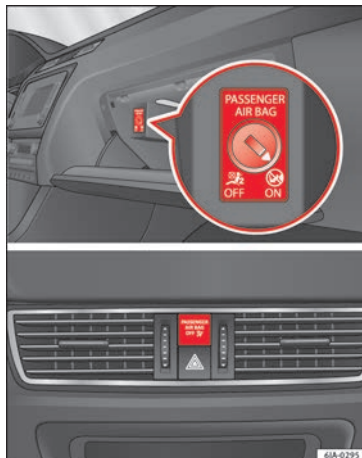
Obr. 82 Spínač čelního airbagu spolujezdce/kontrolka pro vypnutí airbagu spolujezdce
