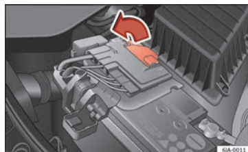
Obr. 210 Akumulátor: otevření krytu
