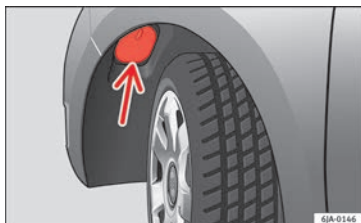
Obr. 92 Výměna žárovky tlumeného světla: Podběh kola
