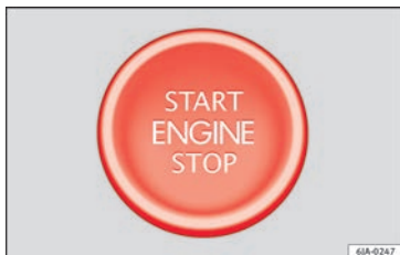
Obr. 174 V sloupku řízení: Startovací tlačítko systému zamykání a startování bez klíče Keyless Access. U vozidel s pravostranným řízením je uspořádání symetrické.
