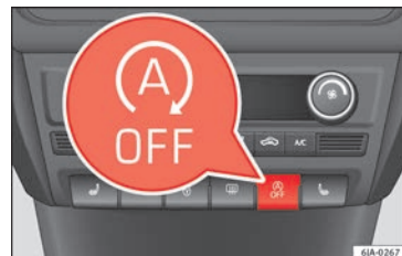
Obr. 192 Panel přístrojů: Tlačítko systému Start-Stop.
