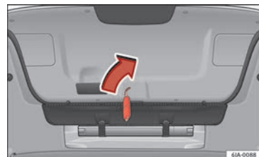
Obr. 6 Detail zavazadlového prostoru: Přístup k nouzovému odemykání
