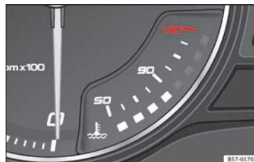
Obr. 113 Panel přístrojů: Ukazatel teploty chladicí kapaliny
