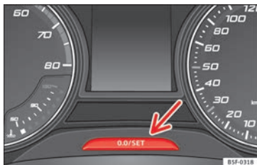
Obr. 112 Panel přístrojů: Počítadlo kilometrů a nulovací tlačítko.
