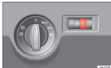
Obr. 132 Panel přístrojů: Nastavení sklonu světlometů
