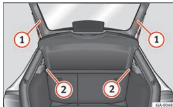
Obr. 166 Demontujte kryt zavazadlového prostoru.
