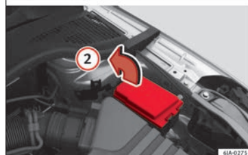
Obr. 88 V motorovém prostoru: Kyt skříně pojistek - varianta 2
