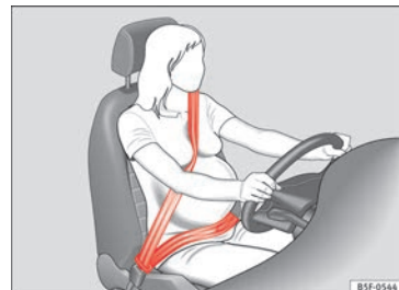
Obr. 80 Průběh bezpečnostního pásu v oblasti hrudi a pánve a u těhotných žen.
