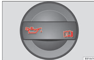
Obr. 51 Víko otvoru pro plnicí otvor motorového oleje
