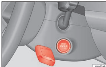
Obr. 175 Nouzové nastartování u vozidel s Keyless Access.
