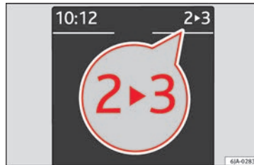
Obr. 38 Panel přístrojů: Ukazatel zařazení převodového stupně (manuální převodovka).
