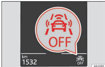
Obr. 191 Na displeji panelu přístrojů: zobrazení, že Front Assist je vypnutý.
