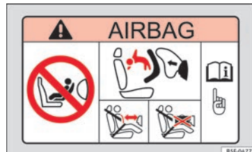
Obr. 22 Sluneční clona na straně spolujezdce: Samolepka airbagu.
