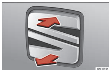
Obr. 128 Zadní výklopné dveře: otevření zvenku
