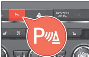
Obr. 213 Středová konzole: Tlačítko asistenta parkování.
