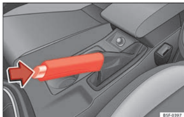
Obr. 185 Ruční brzda mezi předními sedadly.
