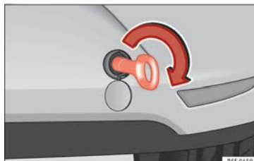
Obr. 100 Zadní nárazník vpravo: zašroubované vlečné oko
