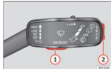
Obr. 43 Páčka stěračů skel: ovládací tlačítka.
