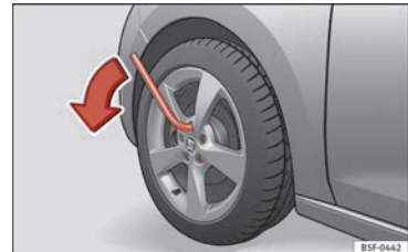
Obr. 73 Kolo: povolte šrouby kol.
