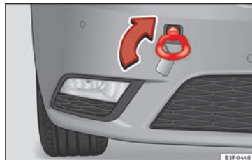
Obr. 98 Přední nárazník vpravo: zašroubované vlečné oko
