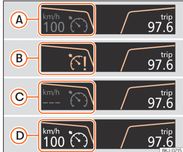
Obr. 267 Na displeji panelu přístrojů: ukážete-li stavu tempomatu.
