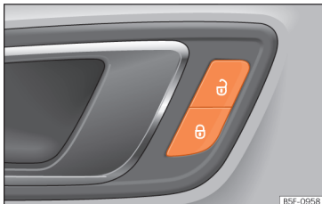
Obr. 97 Dveře řidiče: tlačítko centrálního zamykání dveří.
