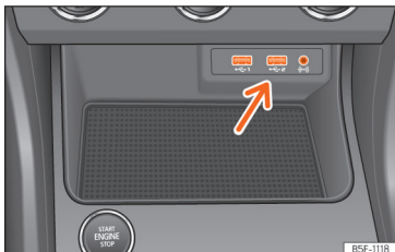
Obr. 250 Středová konzola: Přípojka USB/AUX-IN.
