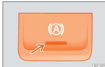
Obr. 287 Ve spodní části středové konzoly: tlačítko funkce Auto Hold.
