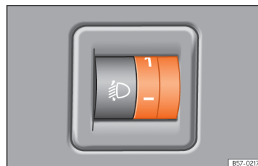
Obr. 118 Vedle volantu: Ovladač regulace dosahu světel.
