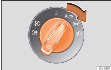
Obr. 114 Přístrojová deska: spínač světel.
