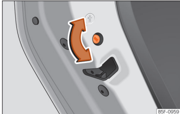
Obr. 104 Dětská pojistka v levých dveřích
