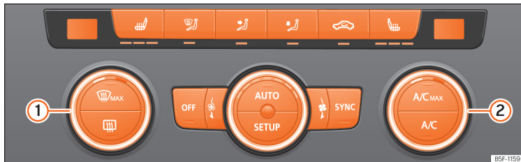
Obr. 170 Ve středové konzole: ovládací prvky Climatronic.
