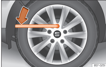
Obr. 38 Výměna kola: povolení šroubů kola.
