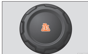
Obr. 320 Motorový prostor: uzávěr vyrovnávací nádobky chladicí kapaliny motoru.
