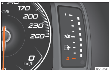
Obr. 80 Volně konfigurovatelný panel přístrojů: palivoměr
