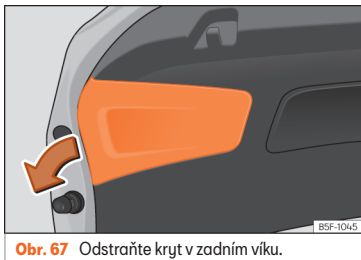
Obr. 67 Odstraňte kryt v zadním víku.
