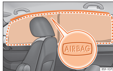
Obr. 23 Místo montáže hlavového airbagu
