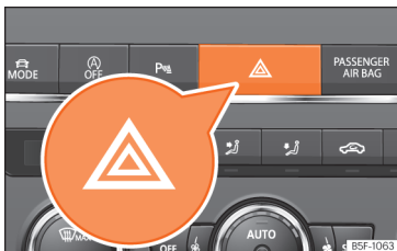
Obr. 117 Přístrojová deska: spínač výstražných světel.
