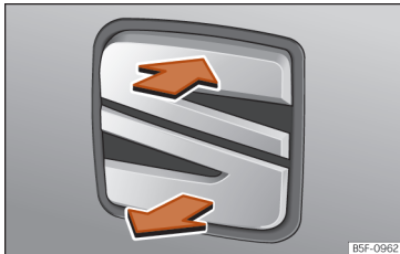
Obr. 105 Zadní víko: otevření zvenku.
