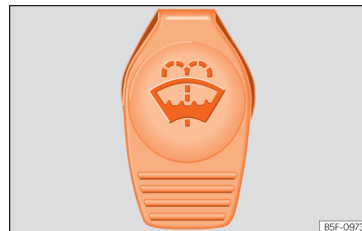
Obr. 322 V motorovém prostoru: uzávěr nádrčky kapaliny do ostříkovačů.
