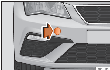
Obr. 47 Na pravé straně předního nárazníku: odstranění krytu.
