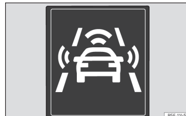
Obr. 269 Na displeji panelu přístrojů: Zobrazení předběžné výstrahy.
