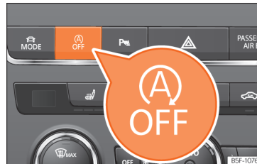
Obr. 257 Středová konzola: Tlačítko systému Start-Stop.
