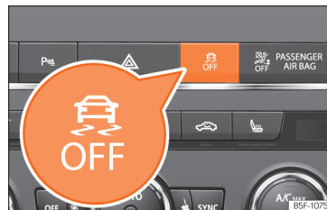
Obř. 288 Středová konzola: Tlačítko pro zapnutí/vypnutí ESC a ASR
