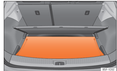
Obr. 142 V zavazadlovém prostoru: Vložení krytu zavazadlového prostoru.
