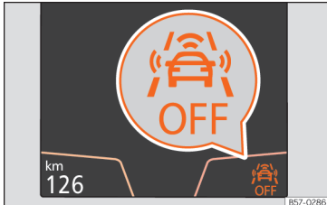
Obr. 271 Na displeji panelu přístrojů: informace o vypnutí systému Front Assist.
