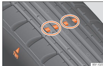
Obr. 324 Vzorek pneumatiky: ukazatele opotřebení.
