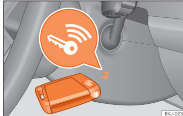
Obr. 256 Vpravo na sloupku řízení: Nouzový start.
