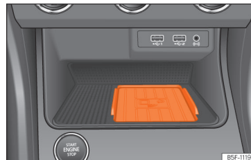
Obr. 253 Ve středové konzole: Úchyt pro spřažení mobilního telefonu.
