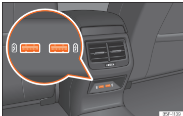
Obr. 251 Středová konzola vzadu: Konektory USB.
