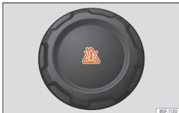
Obr. 52 Motorový prostor: uzávěr vyrovnávací nádržky chladicí kapaliny motoru
