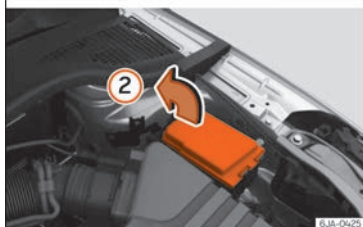
Obr. 88 V motorovém prostoru: Kryt skříňe pojistek - varianta 2
