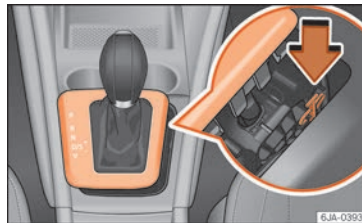
Obr. 45 Nouzové odemykání zámku voliči páky
