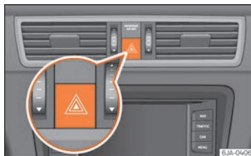
Obr. 32 Přístrojová deska: spínač výstražných světel
