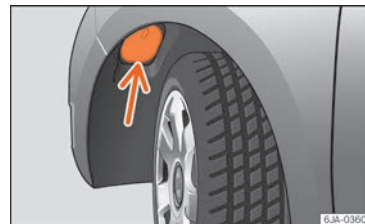
Obr. 92 Výměna žárovky tlumeného světla: Podběh kola
