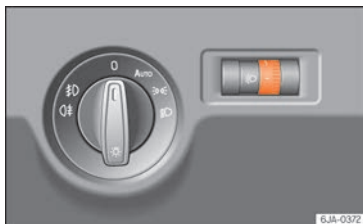
Obr. 130 Panel přístrojů: Nastavení sklonu světlometů
