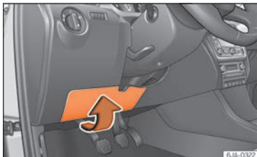
Obr. 55 Na straně řidiče v přístrojové desce: kryt pojistkové skříňky.
