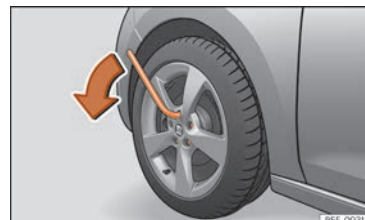
Obr. 63 Výměna kola: Povolení šroubů kol »
