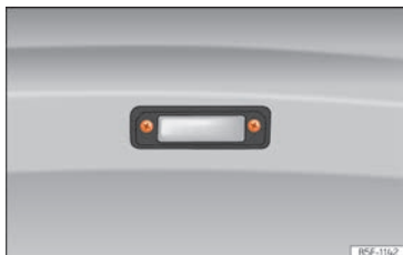
Obr. 108 Demontáž osvětlení registrační značky
