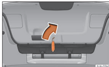
Obr. 8 Detail zavazadlového prostoru: Přístup k nouzovému odemykání
