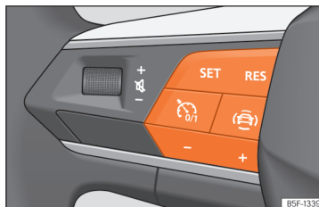
Obr. 137 Na multifunkčním volantu: tlačítka k ovládání tempomatu.
