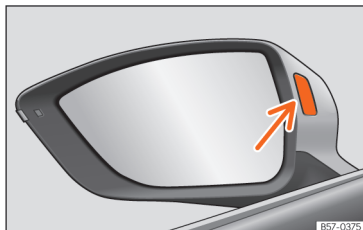
Obr. 150 Kontrolka asistenta změny jízdního pruhu.
