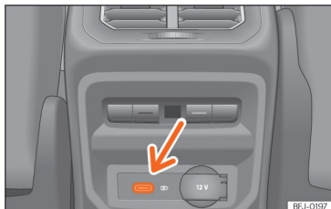
Obr. 185 Středová konzola vzadu: Přípojky USB s funkcí zásuvky.
