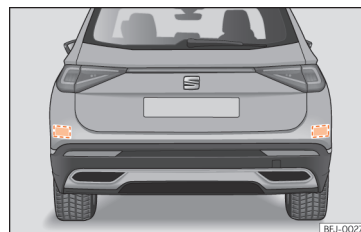
Obr. 134 Oblast za vozidlem: oblasti radarových snímačů.
