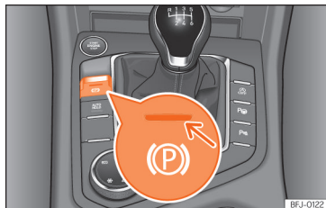
Obr. 154 Ve spodní oblasti středové konzoly: tlačítko elektronické parkovací brzdy.
