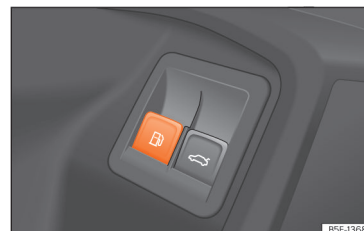
Obr. 215 Dveře řidiče: odjističení víka plnicího hrdla palivové nádrže.
