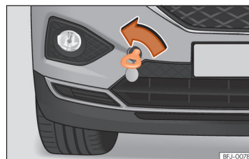
Obr. 225 Přední nárazník vpravo: zašroubované vlečné oko
