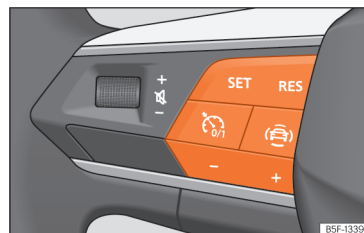
Obr. 138 Na multifunkčním volantu: tlačítka k ovládání omezovače rychlosti.
