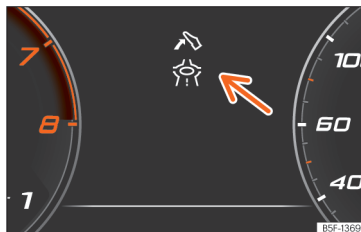
Obr. 14 Signalizace asistenta pro ekologický způsob jízdy (schématické znázornění).
