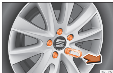
Obr. 250 Kolo: šrouby kola s víkem.
