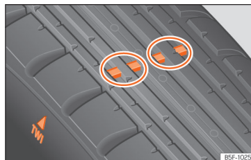
Obr. 246 Vzorok pneumatiky: ukazatele opotřebení.
