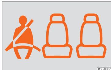
Obr. 22 Panel přístrojů: signalizace stavu bezpečnostních pásů pro zadní sedadla.
