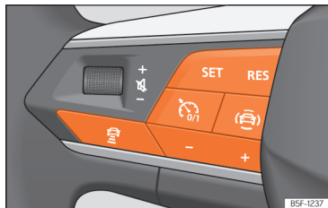
Obr. 140 Na multifunkčním volantu: tlačítka k ovládání systému ACC.
