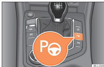
Obr. 161 Ve středové konzole: tlačítko pro zapnutí navigačního parkovacího asistenta.
