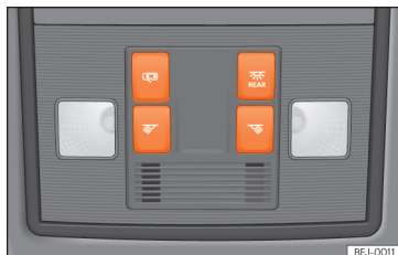
Obr. 106 Výřez stropního panelu: vnitřní osvětlení vpředu.
