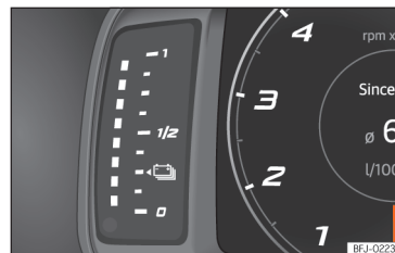
Obr. 8 Panel přístrojů: signalizace stavu nabití akumulátoru.
