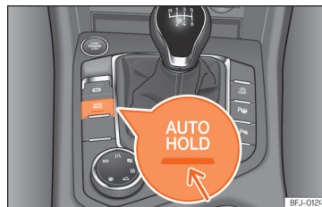
Obr. 155 Ve spodní oblasti středové konzoly: tlačítko funkce AutoHold.
