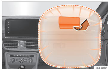
Obr. 31 Airbag spolujezdce v přístrojové desce.
