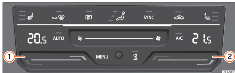
Obr. 112 Ve středové konzole: ovládací prvky pro Climatronic.
