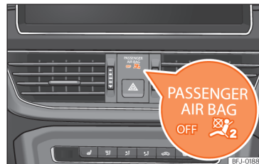
Obr. 33 Přístrojová deska: kontrolka deaktivovaného airbagu spolujezdce.
