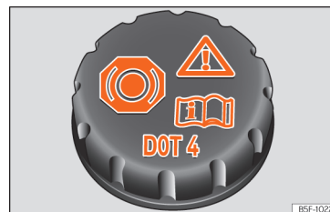
Obr. 237 Motorový prostor: uzávěr nádržky brzdové kapaliny
