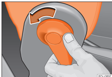
Obr. 90 Odjištění sklápěcího opěradla sedadla spolujezdce
