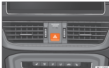
Obr. 49 Přístrojová deska: spínač výstražných světel.
