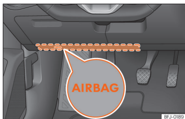
Obr. 36 Na straně řidiče: montážní místo kolenního airbagu.
