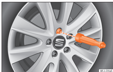
Obr. 256 Výměna kola: vyšroubujte šrouby kol rukojeti šroubováku.
