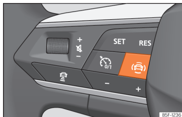
Obr. 130 Levá strana multifunkčního volantu: tlačítka asistenčních systémů řidiče (v závislosti na modelu).
