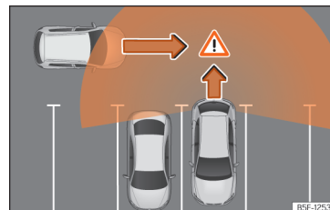
Obr. 174 Schematické vyobrazení asistenta vyparkování: sledovaná oblast vjíždějícího vozidla.
