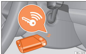
Obr. 119 Vpravo na sloupku řízení: nouzový start.
