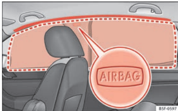
Obr. 27 Místo montáže hlavového airbagu
