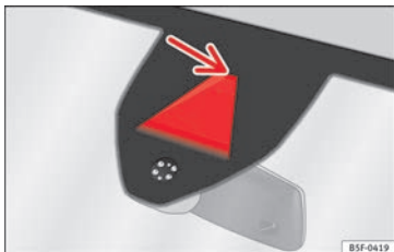
Obr. 214 Kamerový nahlížeč otvor asistentu pro udržení jízdního pruhu.
