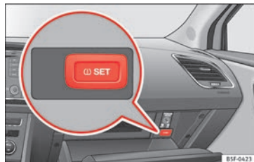
Obr. 247 Odkládací přihrádka: Spínač ukazatele kontroly pneumatik.
