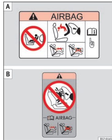
Obr. 28 Samolepka airbagu - verze 1: na sluneční cloně spolujezdce A a na zadním rámu dveří spolujezdce B .
