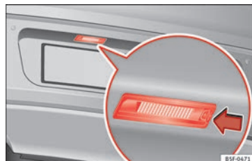
Obr. 117 Zadní nárazník: Osvětlení státní poznávací značky.
