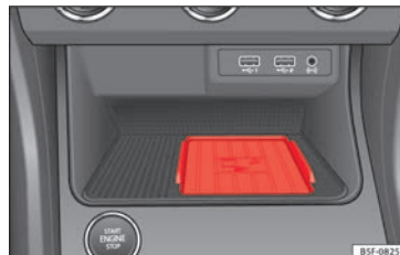
Obr. 127 Středová konzole: Connectivity Box
