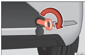
Obr. 99 Zadní nárazník vpravo: zašroubované vlečné oko
