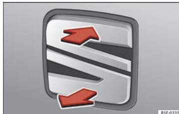
Obr. 5 Zadní výklopné dveře: otevření zvenku
