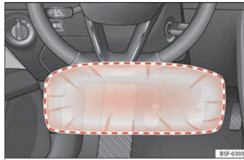
Obr. 24 Na straně řidiče: oblast účinnosti kolenního airbagu.
