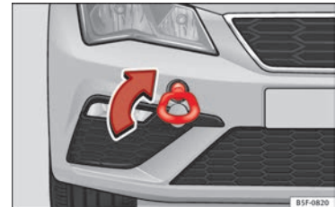
Obr. 75 Přední nárazník vpravo: zašroubované vlečné oko
