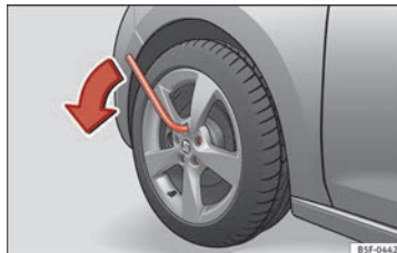
Obr. 72 Kolo: povolte šrouby kol.
