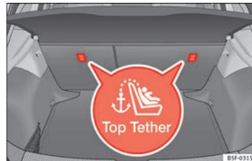
Obr. 32 Poloha ok Top Tether v zadní části zadního sedadla
