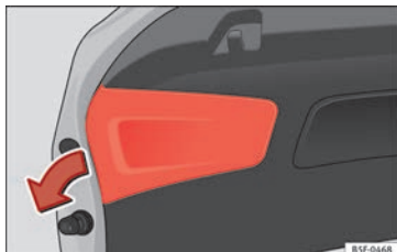
Obr. 115 Odstranění krytu ve víku zavazadlového prostoru
