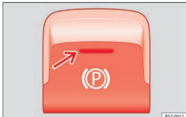
Obr. 188 Ve spodní části středové konzoly: Tlačítko elektronické parkovací brzdy.
