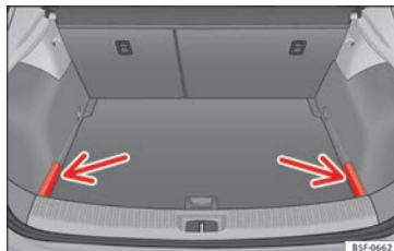
Obr. 163 V zavazadlovém prostoru: Poklopy k uložení krytu zavazadlového prostoru.
