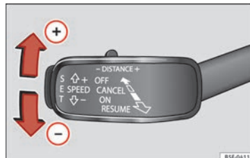
Obr. 201 Na levé straně sloupku řízení: třetí páčka pro ovládání automatické regulace odstupu.
