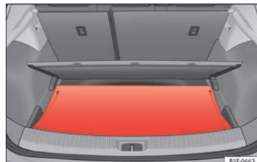
Obr. 164 V zavazadlovém prostoru: Nasazení krytu zavazadlového prostoru.
