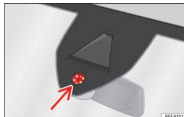
Obr. 144 Citlivá plocha dešťového snímače.
