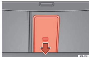
Obr. 172 V zavazadlovém prostoru: otvor průchozího úložného zařízení.
