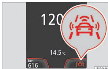
Obr. 209 Na displeji panelu přístrojů: zobrazení, že Front Assist je vypnutý.
