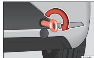
Obr. 76 Zadní nárazník vpravo: zašroubované vlečné oko
