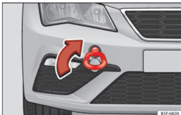
Obr. 97 Přední nárazník vpravo: zašroubované vlečné oko
