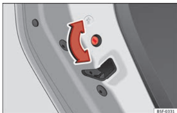
Obr. 134 Bezpečnostní dětská pojistka v levých dveřích
