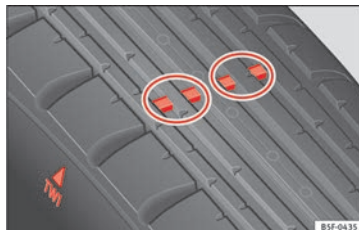
Obr. 175 Vzorek pneumatiky: ukazatele opotřebení.
