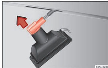
Obr. 91 Světlo registrační značky: Demontáž nosiče žárovky.
