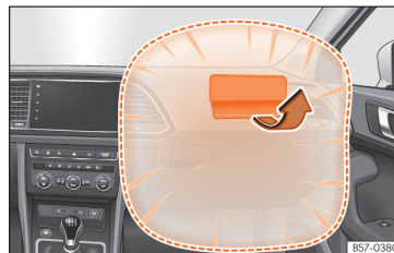
Obr. 15 Airbag spolujezdce v panelu přístrojů
