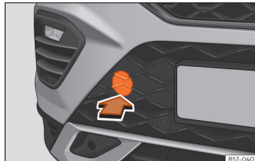
Obr. 45 Na pravé straně předního nárazníku: odstranění krytu.
