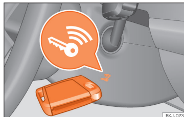
Obr. 150 Vpravo na sloupku řízení: Nouzový start.
