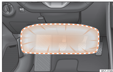
Obr. 19 Na straně řidiče: oblast působnosti kolenního airbagu.
