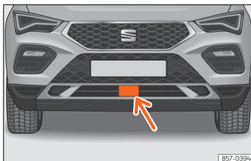
Obr. 158 Na předním nárazníku: radarový snímač.
