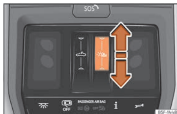
Obr. 89 Ve stropním panelu: ovládání protisluneční rolety.
