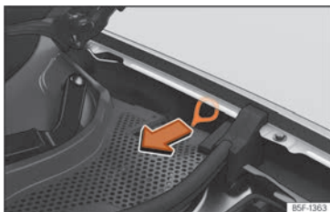
Obr. 64 Mezi levým blatníkem a závěsem víka motorového prostoru: tažná rukojeť ručního odjišťování nabíjecího konektoru.
