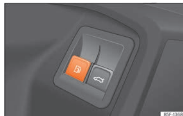
Obr. 209 Dveře řidiče: odjistění víka plnicího hrdla palivové nádrže.
