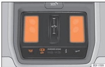
Obr. 106 Výřez stropního panelu: vnitřní osvětlení vpředu.
