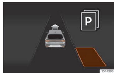
Obr. 157 Na displeji panelu přístrojů: zobrazení parkovacího asistenta s omezeným výhledem.
