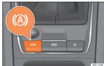
Obr. 154 Ve spodní oblasti středové konzoly: tlačítko funkce Auto Hold.
