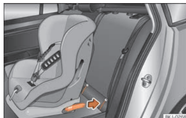
Obr. 45 Zadní sedadla: montáž dětské sedačky pomocí systému ISOFIX.
