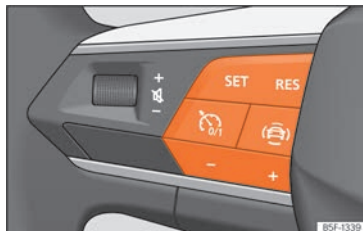
Obr. 133 Na multifunkčním volantu: tlačítka k ovládání omezovače rychlosti.
