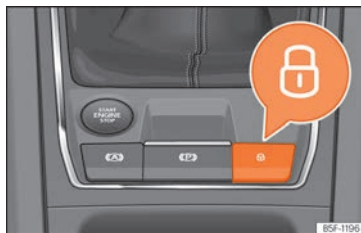
Obr. 76 Na středové konzole: tlačítko centrálního zamykání
