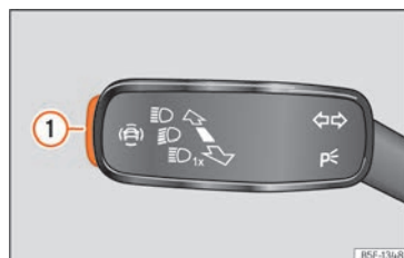
Obr. 124 Na páčce směrových a dálkových světel: tlačítko asistenčních systémů řidiče (v závislosti na modelu).
