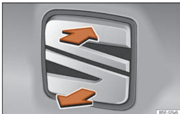
Obr. 80 Zadní víko: otvírání zvenku
