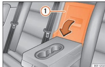
Obr. 199 Na opěradle zadního sedadla: otvor zařízení pro průchozí nakládání.
