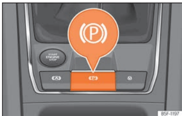
Obr. 153 Ve spodní oblasti středové konzoly: tlačítko elektronické parkovací brzdy.
