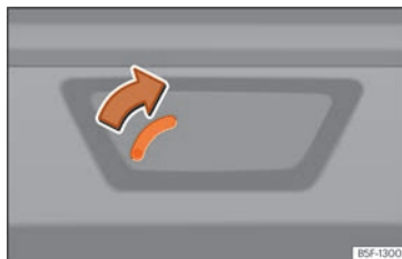
Obr. 85 Detail zavazadlového prostoru: nouzové odemknutí (Leon Sportstourer).
