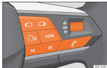
Obr. 13 Pravá strana multifunkčního volantu: ovládací prvky pro menu a zobrazování informací v panelu přístrojů (závisí na modelu).
