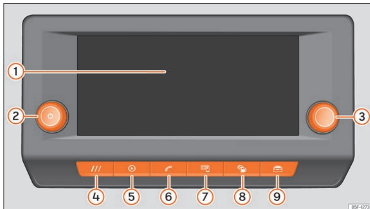
Obr. 174 Všeobecný přehled: ovládací prvky a zobrazení pro 8,25" provedení.
