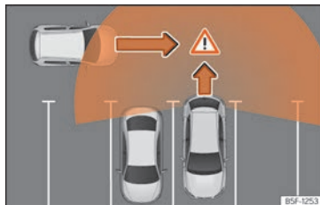
Obr. 163 Schematické vyobrazení asistenta vyparkování: sledovaná oblast vyjíždějícího vozidla.
