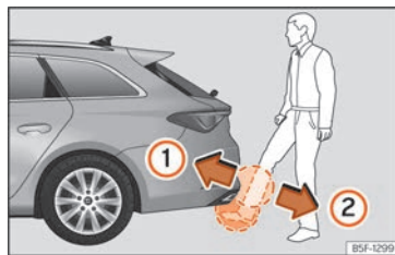
Obr. 83 Zadní víko se snímači řízeným otvíráním a zavíráním (Easy Open).
