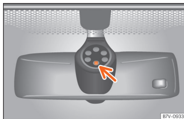
Obr. 122 Citlivá plocha snímače deště.
