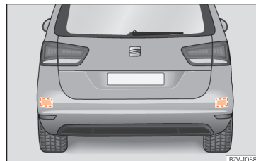
Obr. 261 Pohled na zad' vozidla: Oblasti radarových snímačů.
