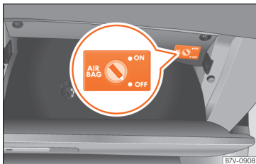
Obr. 18 Ve schránce v přístrojové desce na straně spolujezdce: klíčový spínač k aktivaci a deaktivaci zapnutí čelního airbagu na straně spolujezdce.
