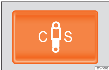
Obr. 243 Ve středové konzole: tlačítko pro nastavení adaptivní regulace podvozku.
