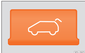
Obr. 102 Ve středové konzole: Odjišťovací tlačítko zadního víka.
