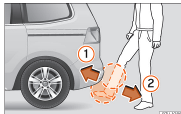
Obr. 106 Zadní víko s otvíráním řízeným snímačem (Easy Open).
