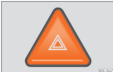
Obr. 117 Přístrojová deska: spínač výstražných světel.
