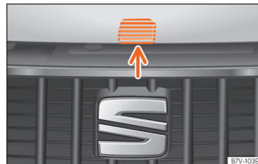
Obr. 287 Páčka pod víkem motorového prostoru.
