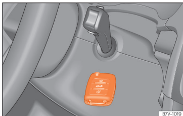
Obr. 235 Nouzové nastartování u vozidel s Keyless Access.
