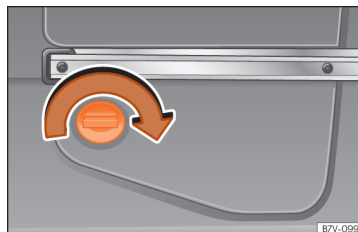
Obr. 284 V zavazadlovém prostoru vzadu vlevo: nádržka pro AdBlue za krytem.
