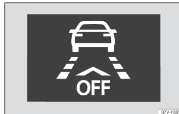
Obr. 248 Na displeji panelu přístrojů: informace o vypnutí systému Front Assist.
