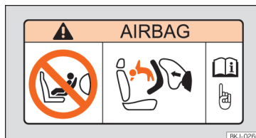
Obr. 27 Nálepka pro airbag: na sluneční cloně na straně spolujezdce
