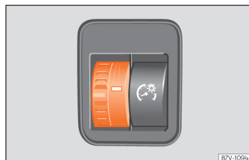
Obr. 119 Vedle volantu: ovladač osvětlení přístrojů a spínačů
