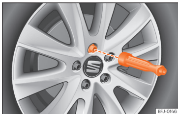
Obr. 49 Výměna kola: vyšroubujte šrouby kol rukojeti šroubováku.
