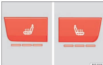
Obr. 151 Ve středové konzole: Ovladač vyhřívání předních sedadel.
