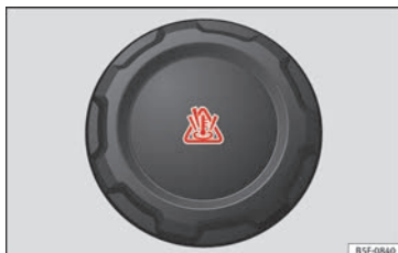
Obr. 63 Motorový prostor: uzávěr vyrovnávací nádržky chladicí kapaliny motoru
