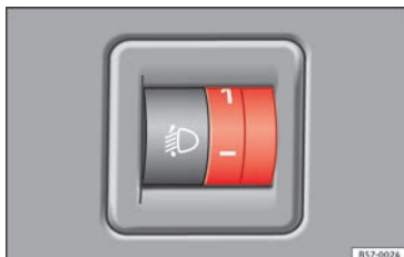
Obr. 145 Vedle volantu: Ovladač regulace sklonu světlometů.
