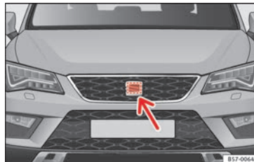
Obr. 196 V přední části za logem SEAT: radarový senzor.
