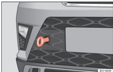
Obr. 77 Přední nárazník vpravo: zašroubované vlečné oko
