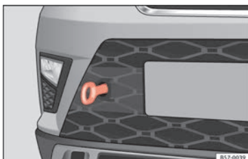
Obr. 99 Na pravé straně předního nárazníku: zašroubované vlečné oko.
