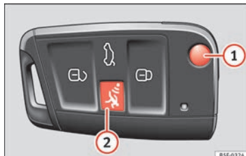
Obr. 129 Klíč od vozidla s tlačítkem alarmu.
