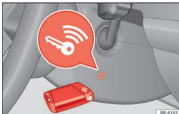
Obr. 179 Vpravo na sloupku řízení: Nouzové start.
