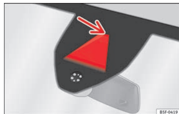
Obr. 202 Kamerový nahlížecí otvor asistentů pro udržení jízdního pruhu.
