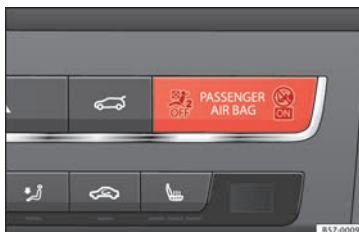
Obr. 53 Kontrolka deaktivace airbagu spolujezdce.
