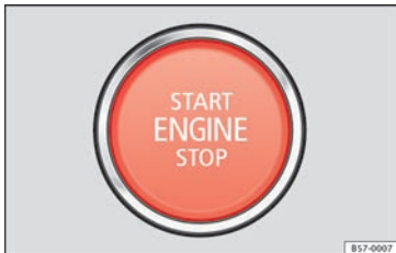
Obr. 178 Ve spodní části středové konzoly: Startovací tlačítko.
