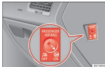
Obr. 22 Spínač čelního airbagu spolujezdce.
