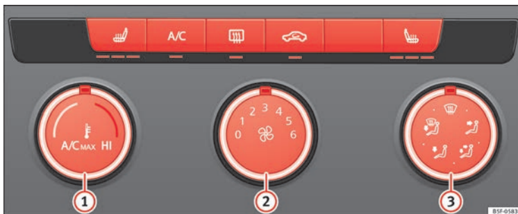
Obr. 58 Ve středové konzole: Ovládací prvky manuální klimatizace.
