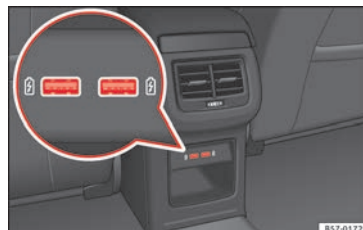
Obr. 158 Středová konzola vzadu: zásuvky USB.
