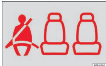
Obr. 89 Panel přístrojů: Zobrazení, že místo vzadu vpravo je obsazeno a příslušný bezpečnostní pás je připnut.
