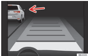
Obr. 199 Na displeji panelu přístrojů: ACC aktivní, identifikováno vozidlo na levé straně
