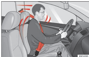
Obr. 90 Řidiči se správně připnutými pásy nebudou při náhlém brzdění vyvrženi dopředu.
