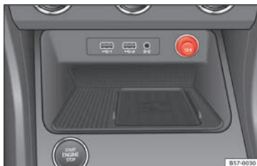
Obr. 157 Ve středové konzole vzadu: zásuvka 12 V.
