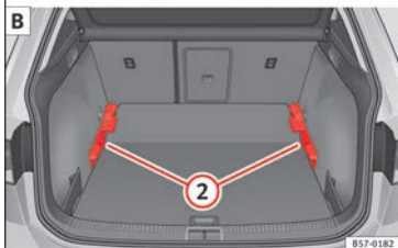
Obr. 169 Variabilní podlaha zavazadlového prostoru: A vysoká poloha; B nízká poloha.
