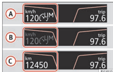
Obr. 187 Na displeji panelu přístrojů: zobrazení stavu omezovače rychlosti.
