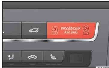
Obr. 23 Přístrojová deska: Kontrolka deaktivovaného airbagu spolujezdce.
