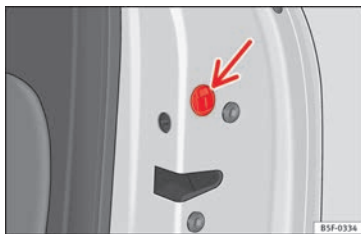
Obr. 4 Nouzové zablokování dveří.
