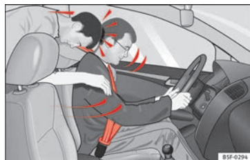
Obr. 92 Nepřipoutaný cestující na zadním sedadle je vymrštěn dopředu na připoutaného řidiče.
