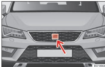
Obr. 191 V přední části za logem SEAT: radarový senzor.
