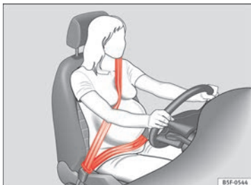
Obr. 94 Průběh bezpečnostního pásu u těhotné ženy.
