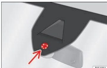
Obr. 175 Snímač vlhkosti a teploty čelního skla.
