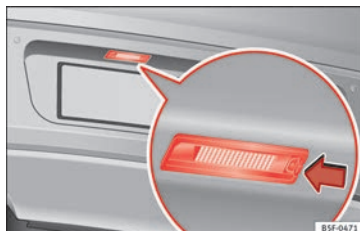
Obr. 115 Zadní nárazník: Osvětlení státní poznávací značky.
