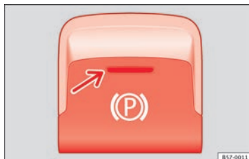
Obr. 180 Ve spodní části středové konzoly: Tlačítko elektronické parkovací brzdy.
