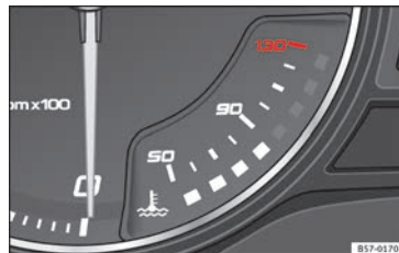
Obr. 121 Panel přístrojů: Ukazatel teploty chladicí kapaliny.
