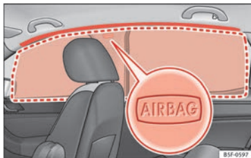
Obr. 28 Místo montáže hlavového airbagu
