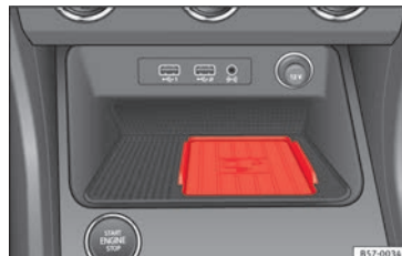
Obr. 127 Středová konzole: Connectivity Box
