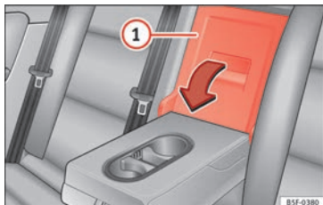
Obr. 163 Na opěradle zadního sedadla: otvor průchozího úložného zařízení.
