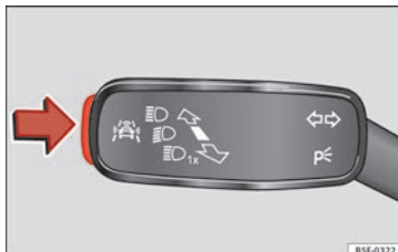
Obr. 45 Na páčce ukazatele směru jízdy (směrových světel) a dálkových světel: Tlačítko asistenčních systémů řidiče.
