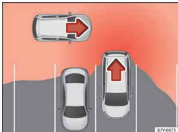
Obr. 211 Schematické zobrazení asistenta pro vyparkování: kontrolovaná oblast kolem vyjíždějícího vozidla.
