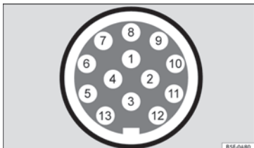
Obr. 236 Schématické zobrazení: Přřazení konektorových kolíků pro napájení přívěsu.
