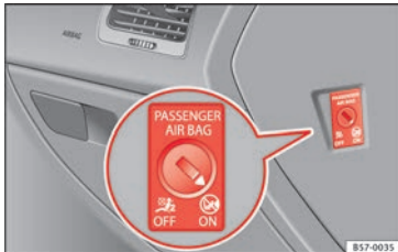
Obr. 95 Spínací klíč pro vypnutí a zapnutí airbagu spolujezdce.
