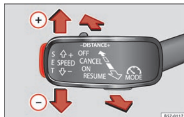
Obr. 50 Vlevo od sloupku řízení: Třetí páčka pro ovládání tempomatu.
