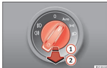
Obr. 143 Přístrojová deska: Ovládací prvek světel
