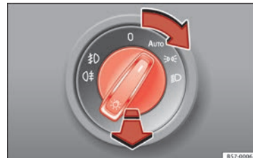
Obr. 36 Přístrojová deska: Ovládací prvek světel
