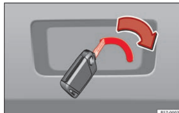
Obr. 8 Detail zavazadlového prostoru: Nouzové odemknutí.
