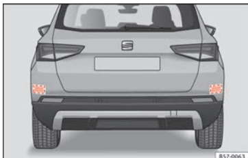
Obr. 208 Oblast za vozidlem: Oblasti radarových snímačů.
