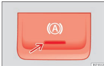
Obr. 185 Ve spodní části středové konzoly: Tlačítko funkce Auto-Hold.
