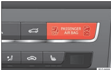
Obr. 96 Přístrojová deska: Kontrolka deaktivovaného airbagu spolujezdce.
