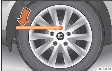
Obr. 240 Výměna kola: Povolení šroubů kola
