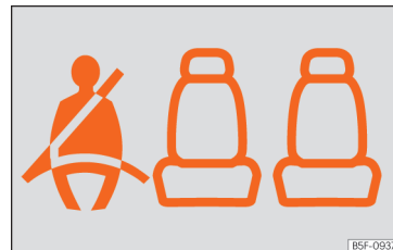
Obř. 23 Panel přístrojů: signalizace stavu bezpečnostních pásů pro zadní sedadla.
