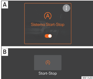
Obr. 116 Na displeji systému infotainmentu: zapnutý systém Start-Stop. A náhled v hlavním menu. B náhled při vypnutém systému infotainmentu.
