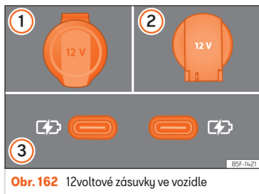
Obr. 162 12voltové zásuvky ve vozidle
