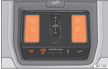
Obr. 103 Výřez stropního panelu: vnitřní osvětlení vpředu.
