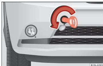
Obr. 80 Přední nárazník vpravo: našroubování vlečného oka.
