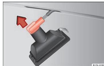
Obr. 89 Světlo registrační značky: Demontáž nosiče žárovky.
