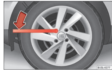
Obr. 52 Výměna kola: povolte šrouby kol.
