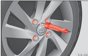
Obr. 56 Výměna kola: našroubování šroubů kol rukojetí šroubováku.
