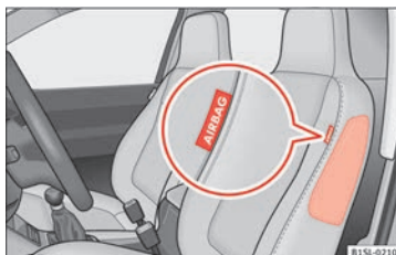
Obr. 21 Na straně předního sedadla: umístění bočního airbagu.
