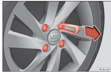
Obr. 51 Stáhnutí krytek ze šroubů kola
