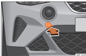
Obr. 162 Na pravé straně předního nárazníku: odstranění krytu.
