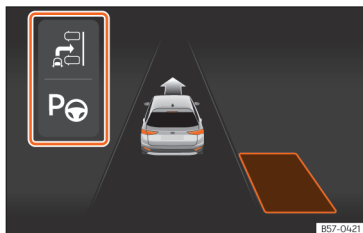
Obr. 123 Na displeji panelu přístrojů: zobrazení parkovacího asistenta s omezeným výhledem.
