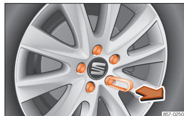
Obr. 192 Kolo: šrouby kola s víkem.
