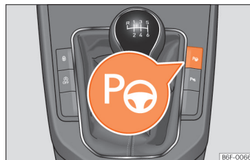
Obr. 122 Ve středové konzole: tlačítko pro zapnutí naváděcího parkovacího asistenta.
