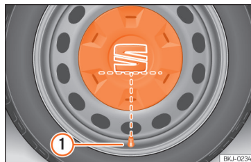
Obr. 191 Správné umístění celoplošného krytu kola u ocelových disků.
