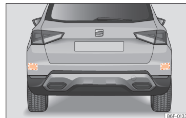
Obr. 97 Oblast za vozidlem: oblasti radarových snímačů.
