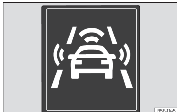
Obr. 165 Na displeji panelu přístrojů: signalizace předběžné výstrahy.
