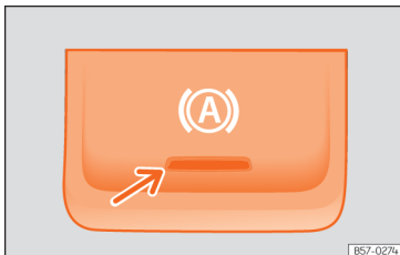
Obr. 183 Ve spodní části středové konzoly: tlačítko funkce Auto Hold.
