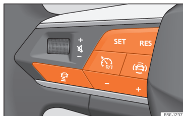
Obr. 168 Na multifunkčním volantu: tlačítka k ovládání systému ACC
