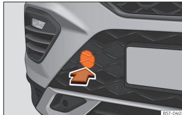
Obr. 45 Na pravé straně předního nárazníku: odstranění krytu.
