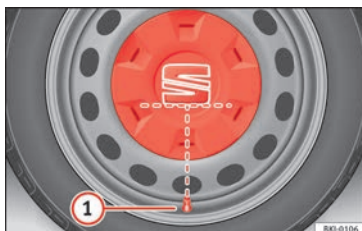
Obr. 76 Správné umístění celoplošného krytu kola u ocelových disků.
