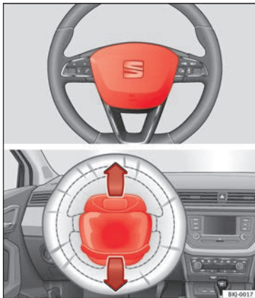
Obr. 20 Místo montáže airbagu řidiče: ve volantu.
