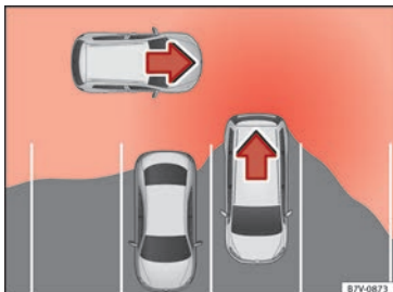
Obr. 205 Schematické zobrazení asistenta pro vyparkování: kontrolovaná oblast kolem vyjíždějícího vozidla.
