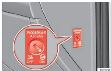
Obr. 102 Spínací klíč pro vypnutí a zapnutí airbagu spolujezdce.
