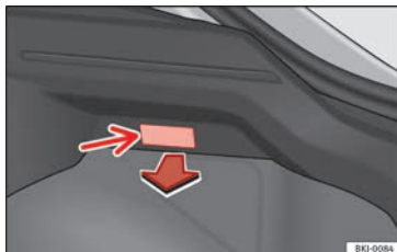
Obr. 121 Světlo zavazadlového prostoru*
