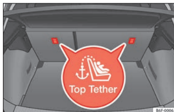
Obr. 31 Poloha ok Top Tether v zadní části zadního sedadla
