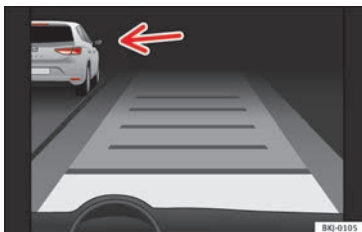
Obr. 198 Na displeji panelu přístrojů: ACC aktivní, identifikováno vozidlo na levé straně
