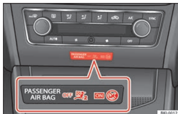
Obr. 103 Střední díl přístrojové desky: Kontrolka při odpojení airbagu spolujezdce.
