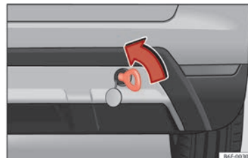
Obr. 108 Zadní nárazník vpravo: zašroubované vlečné oko
