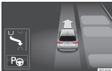
Obr. 211 Na displeji panelu přístrojů: vizualizace parkovacího asistenta s miniaturním náhledem.
