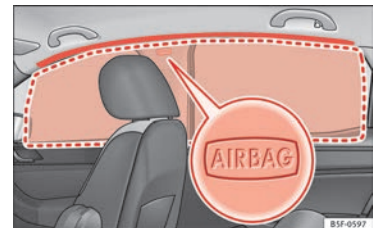
Obr. 25 Umístění a oblast nafouknutí hlavového airbagu.
