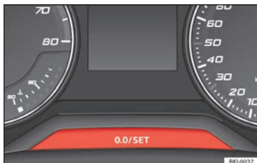
Obr. 125 Panel přístrojů: Počítadlo kilometrů a nulovací tlačítko.
