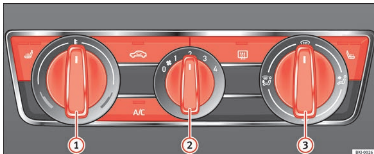
Obr. 171 Ovládací prvky klimatizace v přístrojové desce.
