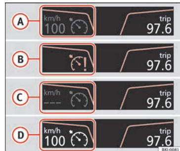
Obr. 183 Displej panelu přístrojů: ukazatele stavu tempomatu.
