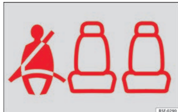
Obr. 96 Panel přístrojů: Zobrazení, že místo vzadu vpravo je obsazeno a příslušný bezpečnostní pás je připnut.
