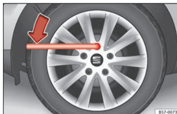
Obr. 80 Výměna kola: Povolení šroubů kol
