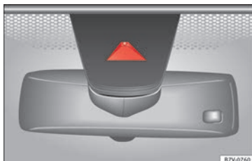
Obr. 219 Na předním skle: Kamerový nahlížeč otvor asistenta pro udržení jízdního pruhu.
