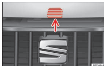
Obr. 239 Odjišťovací páčka pro otevření víka motorového prostoru v mřížce chladiče
