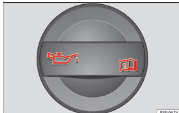
Obr. 242 V motorovém prostoru: víko plnicího otvoru motorového oleje.
