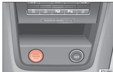
Obr. 199 Ve středové konzole: Startovací tlačítko systému zamykání a startování bez klíče Keyless Access. U vozidel s pravostranným řízením je uspořádání symetrické.
