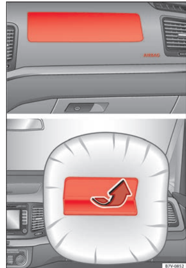
Obr. 27 Montážní poloha a oblast účinnosti čelního airbagu spolujezdce
