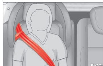
Obr. 97 Integrovaná dětská sedačka: průběh pásu s vodící třmenem
