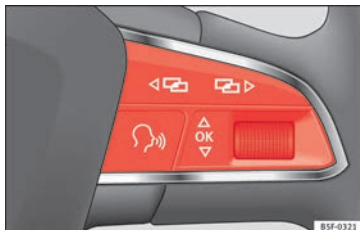
Obr. 46 Multifunkční volant: tlačítka k ovládání nabídek ve sdružených přístrojích
