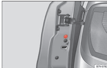
Obr. 4 Na přední části posuvných dveří: nouzové zamykání, zakryto gumovým těsněním.
