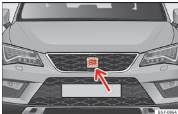
Obr. 185 V přední části za logem SEAT: radarový snímač
