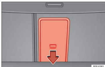
Obr. 159 V zavazadlovém prostoru: otvor průchozího úložného zařízení
