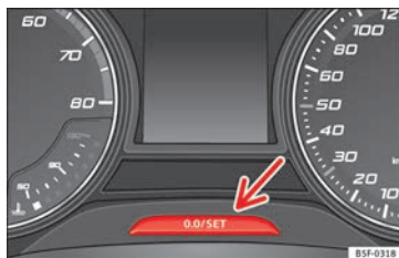
Obr. 118 Panel přístrojů: počítadlo kilometrů a nulovací tlačítko
