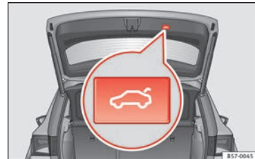
Obr. 6 Zadní výklopné dveře: tlačítko pro zavírání zadních výklopných dveří
