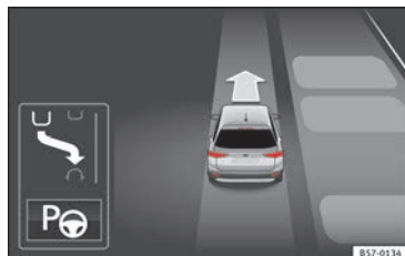
Obr. 214 Na displeji panelu přístrojů: zobrazení parkovacího asistenta s omezenou viditelností
