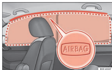
Obr. 27 Místo montáže hlavového airbagu
