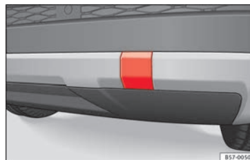
Obr. 99 Na pravé straně zadního nárazníku: odstraňte kryt.
