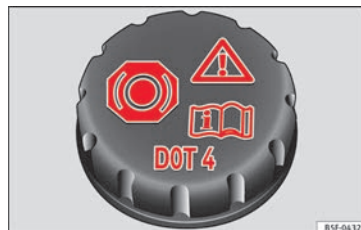
Obr. 62 Motorový prostor: uzávěr nádrčky brzdové kapaliny
