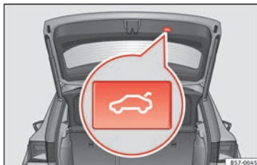
Obr. 133 Otevřené víko zavazadlového prostoru: tlačítko pro okamžité zavírání víka zavazadlového prostoru
