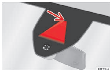
Obr. 199 Kamerový nahlížeč otvor asistent pro udržení jízdního pruhu
