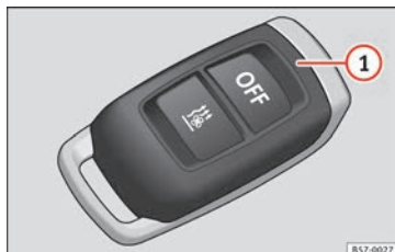
Obr. 168 Nezávislé topení: s rádiovým dálkovým ovládáním
