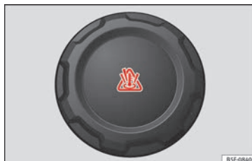
Obr. 61 Motorový prostor: uzávěr vyrovnávací nádržky chladicí kapaliny motoru
