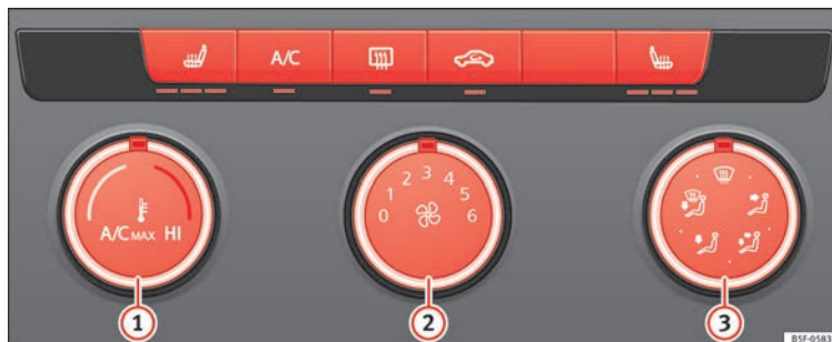
Obr. 56 Ve středové konzole: ovládací prvky manuální klimatizace
