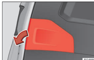
Obr. 112 Otevřené víko zavazadlového prostoru: odstraňte kryt.
