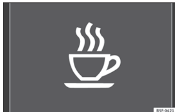
Obr. 210 Na displeji panelu přístrojů: symbol rozpoznání únavy
