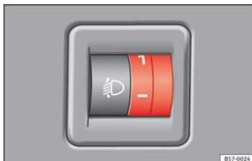
Obr. 141 Vedle volantu: ovladač regulace sklonu světlometů
