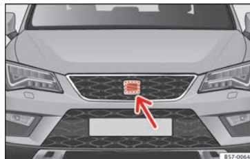
Obr. 193 V přední části za logem SEAT: radarový snímač
