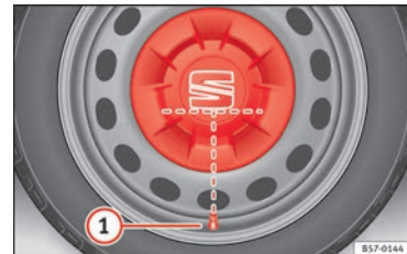
Obr. 69 Správné umístění celoplošného krytu kola u ocelových disků
