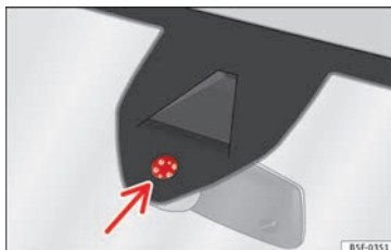
Obr. 144 Citlivá plocha dešťového snímače
