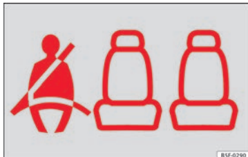
Obr. 87 Panel přístrojů: Zobrazení, že místo vzadu vpravo je obsazeno a příslušný bezpečnostní pás je připnut.
