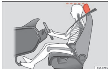
Obr. 83 Správné nastavení opěrky hlavy řidiče
