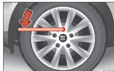
Obr. 72 Kolo: povolte šrouby kol
