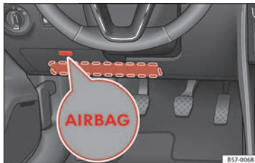
Obr. 23 Na straně řidiče: umístění kolenního airbagu
