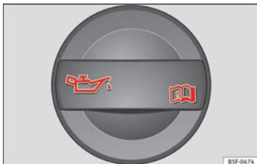
Obr. 236 Víko otvoru pro plnění motorového oleje
