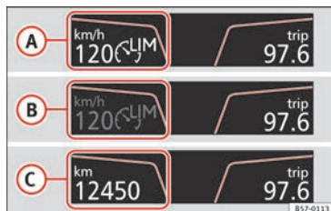
Obr. 179 Na displeji panelu přístrojů: zobrazení stavu omezovače rychlosti
