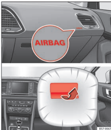
Obr. 21 Airbag spolujezdce v panelu přístrojů
