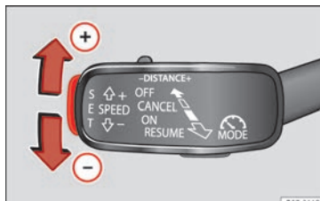
Obr. 187 Na levé straně sloupku řízení: třetí páčka pro ovládání automatické regulace odstupu
