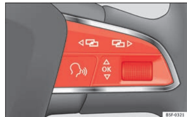
Obr. 43 Pravá strana multifunkčního volantu: ovládací tlačítka
