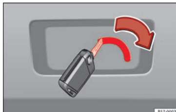
Obr. 8 Detail zavazadlového prostoru: nouzové odemykání
