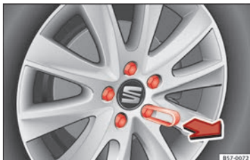
Obr. 70 Kolo: šrouby kola s víkem
