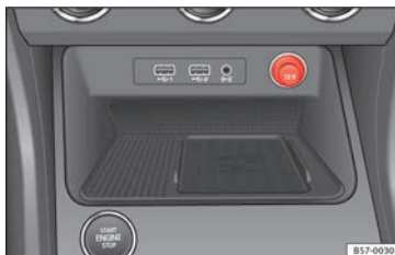
Obr. 153 Ve středové konzole vzadu: zásuvka 12 V
