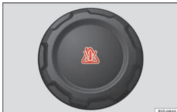
Obr. 171 V motorovém prostoru: víko vyrovnávací nádržky chladicí kapaliny
