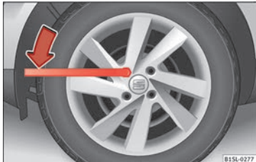
Obr. 53 Výměna kola: povolte šrouby kol
