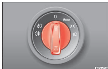
Obr. 109 Vedle volantu: zobrazení některých variant spínače světel
