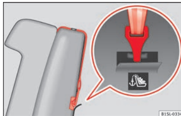
Obr. 27 Příklad zavěšení horního upevňovacího popruhu
