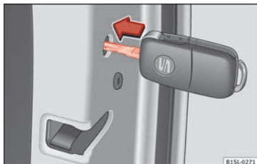
Obr. 5 Nouzové zamykání vozidla klíčem vozidla
