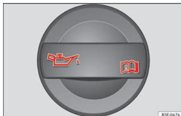
Obr. 169 V motorovém prostoru: víko plnicího otvoru motorového oleje
