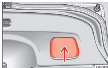
Obr. 6 Otevřené zadní výklopné dveře (zadní víko): zapuštěné madlo pro zavírání zavazadlového prostoru
