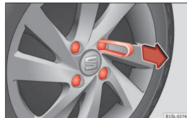
Obr. 52 Stáhnutí krytek ze šroubů kola
