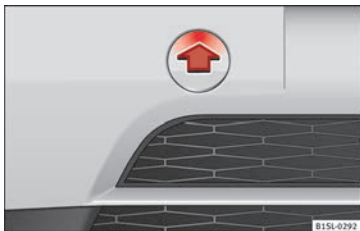
Obr. 80 Přední nárazník vpravo: Sejměte kryt.
