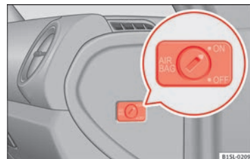
Obr. 75 Na straně spolujezdce: klíčový přepínač k vypnutí a zapnutí čelního airbagu na straně spolujezdce
