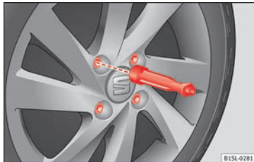
Obr. 57 Výměna kola: našroubování šroubů kol rukojetí šroubováku
