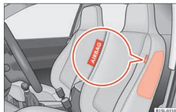
Obr. 21 Na straně předního sedadla: umístění bočního airbagu.
