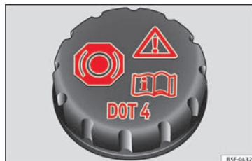
Obr. 43 Motorový prostor: uzávěr nádrčky brzdové kapaliny
