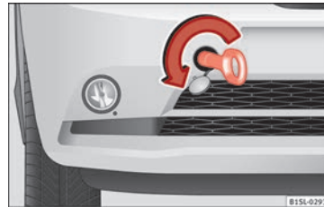
Obr. 58 Přední nárazník vpravo: zašroubované vlečné oko
