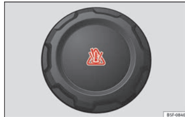
Obr. 42 Motorový prostor: uzávěr vyrovnávací nádržky chladicí kapaliny motoru
