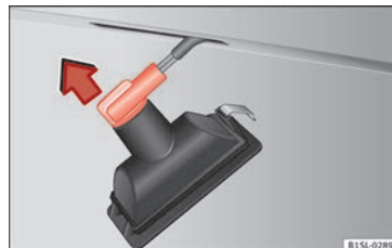
Obr. 91 Světlo registrační značky: demontáž nosiče žárovky
