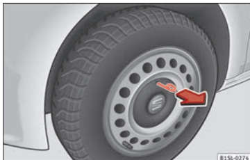
Obr. 50 Stáhněte středový kryt z ocelového disku.
