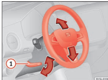
Obr. 17 Mechanické nastavení polohy volantu
