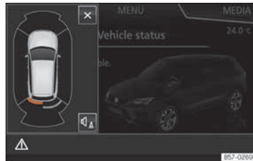
Obr. 288 Miniaturní signalizace automatického zapnutí
