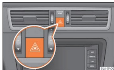
Obr. 133 Panel přístrojů: Spínač výstražných světel
