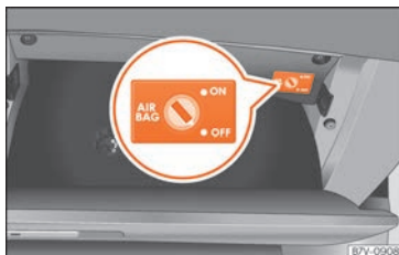
Obr. 29 V odkládací přihrádce na straně spolujezdce: klíčový přepínač k vypnutí a zapnutí čelního airbagu na straně spolujezdce.
