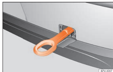
Obr. 106 Zadní nárazník vpravo: zašroubované vlečné oko.
