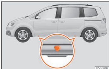
Obr. 71 Upínací body pro nasazení zvedáku.
