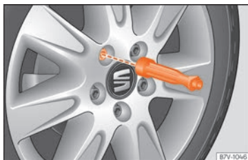
Obr. 73 Výměna kola: našroubování šroubů kol rukojetí šroubováku.
