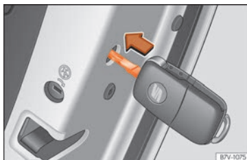
Obr. 7 Nouzové zamykání vozidla klíčem vozidla.
