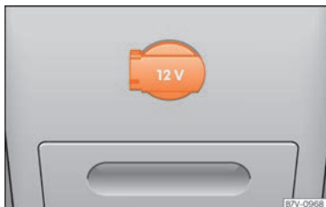
Obr. 197 Zadní strana středové konzole: zásuvka 12V.
