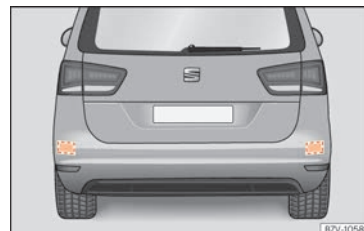
Obr. 272 Oblast za vozidlem: Oblasti radarových snímačů.
