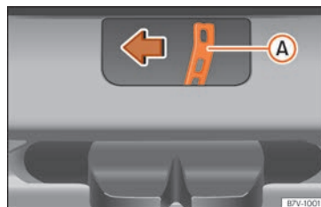
Obr. 11 Ze zavazadlového prostoru: nouzově odemkněte zadní víko.
