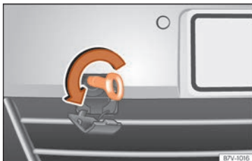
Obr. 74 Přední nárazník vpravo: našroubování vlečného oka.
