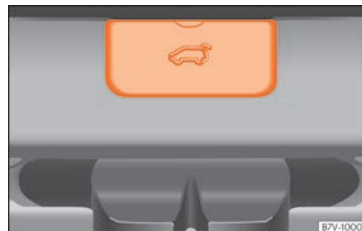
Obr. 10 Ze zavazadlového prostoru: Demontáž krytu zadního víka.
