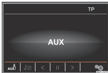
Obr. 213 Provoz médií: Připojení externího zdroje audio na zdiřku AUX-IN
