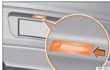
Obr. 121 Zadní nárazník: Osvětlení státní poznávací značky.
