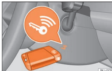
Obr. 253 Vpravo na sloupku řízení: Nouzový start.
