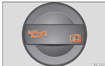
Obr. 63 Víko otvoru pro plnicí otvor motorového oleje
