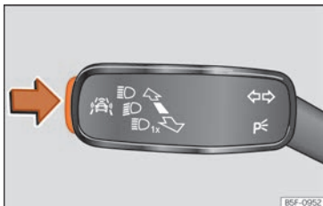
Obr. 138 Na páčce směrových světel a dálkových světel lze zapínat nebo vypínat tlačítko asistenčních systémů řidiče.
