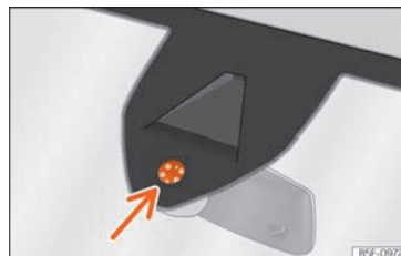
Obr. 157 Citlivá plocha dešťového snímače.
