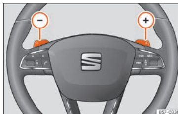
Obr. 260 Volant: páčky pro automatickou převodovku.
