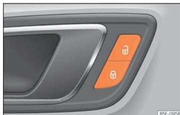
Obr. 5 Dveře řidiče: tlačítko centrálního zamykání.
