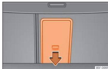
Obr. 184 V zavazadlovém prostoru: otvor průchozího úložného zařízení.
