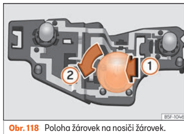
Obr. 118 Poloha žárovek na nosiči žárovek.
