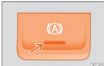
Obr. 263 Ve spodní části středové konzoly: Tlačítko funkce Auto-Hold.
