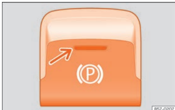
Obr. 255 Ve spodní části středové konzoly: Tlačítko elektronické parkovací brzdy.
