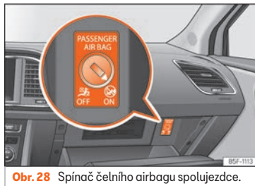
Obr. 28 Spínač čelního airbagu spolujezdce.
