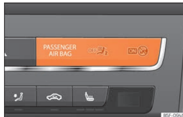
Obr. 29 Přístrojová deska: Kontrolka deaktivovaného airbagu spolujezdce.
