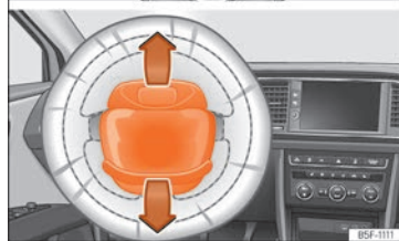
Obr. 26 Místo montáže airbagu řidiče: ve volantu.
