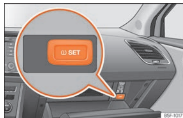
Obr. 316 Odkládací přihrádka: Spínač ukazatele kontroly pneumatik.
