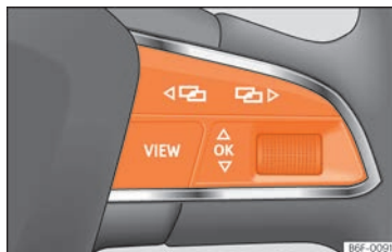
Obr. 137 Pravá strana multifunkčního volantu: ovládací prvky pro menu a zobrazení informací v panelu přístrojů.
