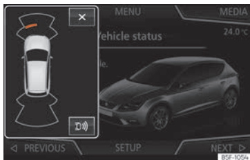
Obr. 286 Miniaturní signalizace automatického zapnutí
