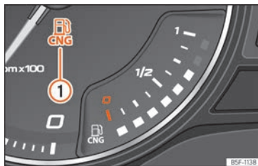
Obr. 133 Analogový panel přístrojů: ukazatel zásoby zemního plynu
