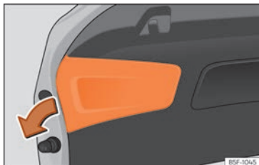
Obr. 119 Odstraňte kryt v zadním víku.
