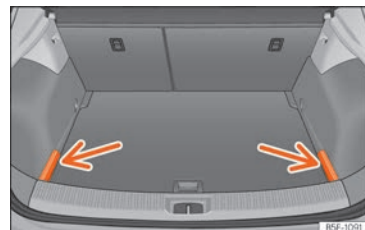
Obr. 175 V zavazadlovém prostoru: Krytky uložení krytu zavazadlového prostoru.
