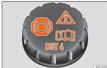
Obr. 65 Motorový prostor: uzávěr nádrčky brzdové kapaliny
