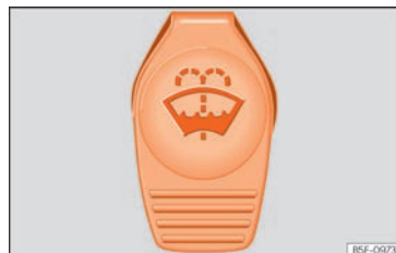
Obr. 66 V motorovém prostoru: uzávěr nádrčky kapaliny do ostřikovačů.
