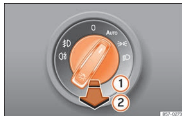
Obr. 151 Přístrojová deska: Ovládací prvek světel
