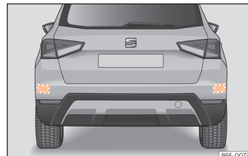
Obr. 241 Pohled na zád vozidla: Oblasti radarových snímačů.
