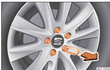
Obr. 35 Kolo: Šrouby kola s víkem.
