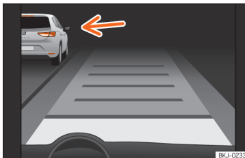
Obr. 237 Na displeji panelu přístrojů: ACC aktivní, identifikováno vozidlo na levé straně
