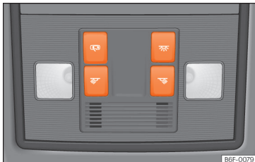
Obr. 111 Detail stropního panelu: osvětlení vnitřního prostoru vpředu.
