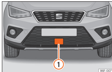
Obr. 228 V předním nárazníku: radarový snímač.
