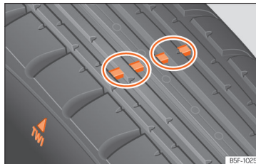
Obr. 289 Vzorok pneumatiky: ukazatele opotřebení.
