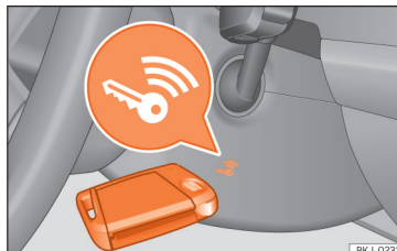
Obr. 210 Vpravo na sloupku řízení: Nouzový start.
