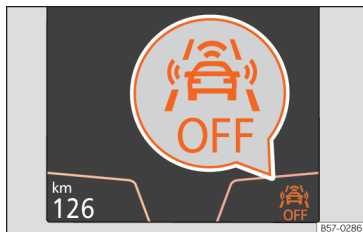
Obr. 229 Na displeji panelu přístrojů: informace o vypnutí systému Front Assist.
