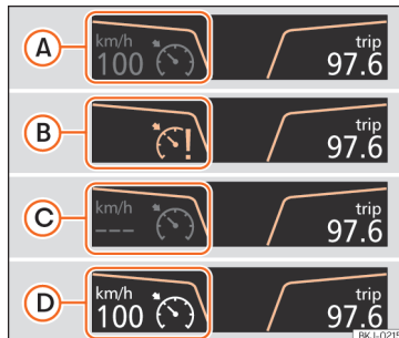
Obr. 221 Na displeji panelu přístrojů: ukazatele stavu tempomatu.
