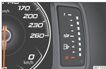
Obr. 74 Volně konfigurovatelný panel přístrojů: palivoměr
