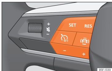
Obr. 102 Na multifunkčním volant: tlačítka k ovládání tempomatu.
