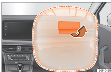
Obr. 28 Airbag spolujezdce v přístrojové desce.
