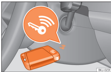
Obr. 86 Vpravo na sloupku řízení: nouzový start.
