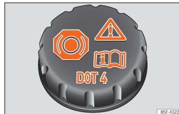
Obr. 172 Motorový prostor: uzávěr nádržky brzdové kapaliny
