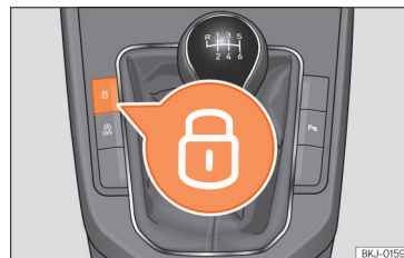
Obr. 52 Středová konzola: tlačítko centrálního zamykání.
