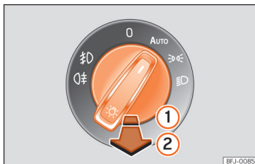
Obr. 72 Přístrojová deska: ovládací prvek světel
