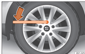
Obr. 187 Výměna kola: Povolení šroubů kola
