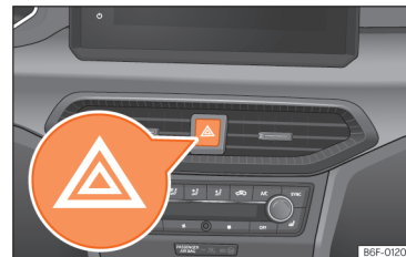
Obr. 43 Přístrojová deska: spínač výstražných světel.
