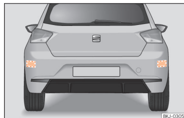
Obr. 99 Oblast za vozidlem: oblasti radarových snímačů.
