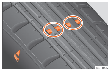
Obr. 180 Vzorek pneumatiky: ukazatele opotřebení.
