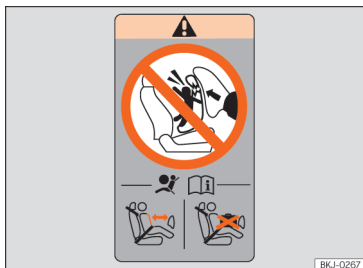
Obr. 36 Štítek airbagu: na horním rámu dveří spolujezdce.
