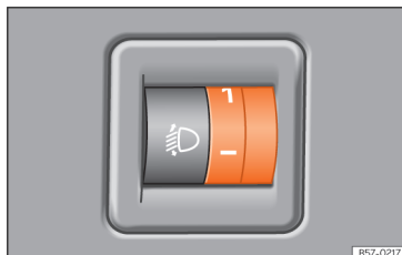
Obr. 74 Vedle volantu: ovladač regulace dosahu světel
