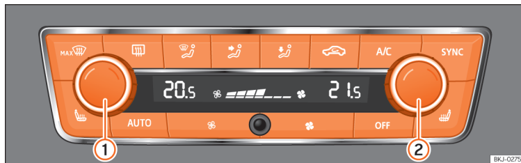
Obr. 82 Ve středové konzole: ovládací prvky pro Climatronic.
