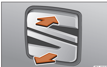
Obr. 57 Zadní víko: otvírání zvenku
