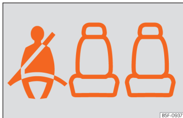
Obr. 20 Panel přístrojů: signalizace stavu bezpečnostních pásů pro zadní sedadla.
