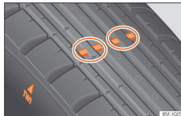
Obr. 251 Vzorok pneumatiky: ukazatele opotřebení.
