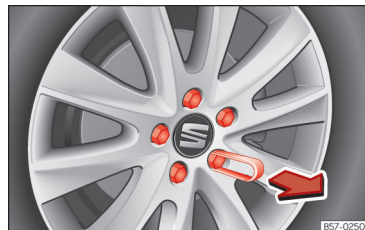
Obr. 193 Kolo: šrouby kola s víkem.
