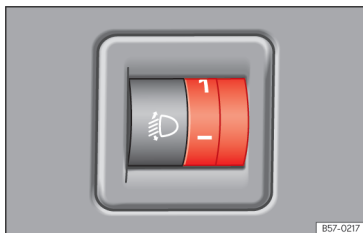
Obr. 70 Vedle volantu: ovladač regulace dosahu světel
