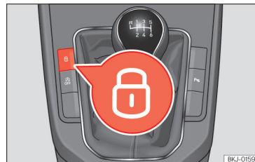
Obr. 50 Středová konzola: tlačítko centrálního zamykání.
