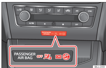
Obr. 28 Střední část přístrojové desky: kontrolka deaktivovaného airbagu spolujezdce.
