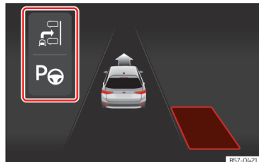
Obr. 124 Na displeji sdružených přístrojů: zobrazení parkovacího asistenta s omezeným výhledem.
