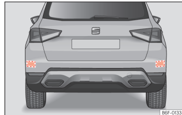
Obr. 95 Oblast za vozidlem: oblasti radarových snímačů.
