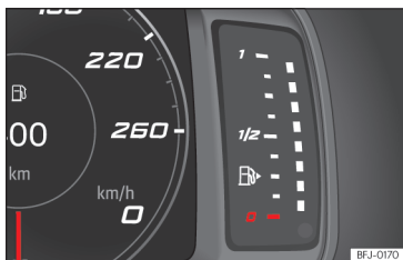
Obr. 4 Sdružené přístroje SEAT Digital Cockpit: Palivoměr.
