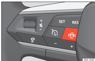
Obr. 91 Levá strana multifunkčního volantu: tlačítko asistenčních systémů řidiče [v závislosti na modelu].
