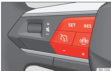
Obr. 98 Na multifunkčním volantu: tlačítka k ovládání tempomatu.
