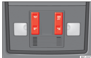
Obr. 71 Výřez stropního panelu: vnitřní osvětlení vpředu.
