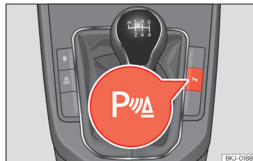
Obr. 120 Středová konzola: Tlačítko parkovacího asistenta (dle provedení).
