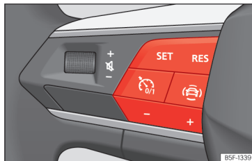
Obr. 99 Na multifunkčním volantu: tlačítka k ovládání omezovače rychlosti.
