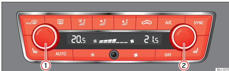
Obr. 78 Ve středové konzole: ovládací prvky pro Climatronic.
