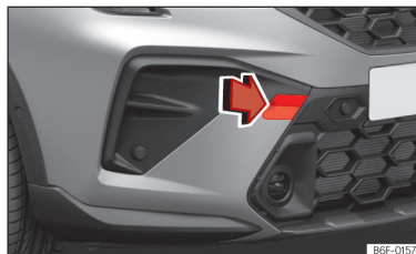
Obr. 163 Na pravé straně předního nárazníku: odstranění krytu.
