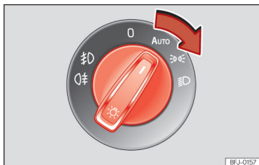
Obr. 67 Přístrojová deska: spínač světel.
