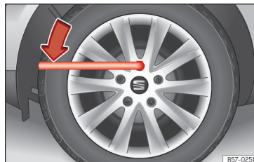
Obr. 195 Výměna kola: povolení šroubů kola
