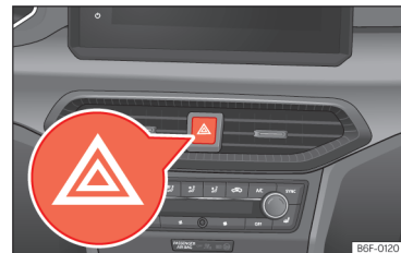
Obr. 41 Přístrojová deska: spínač výstražných světel.
