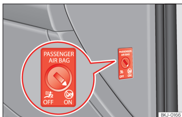
Obr. 27 Klíčem ovládaný spínač pro připojení a odpojení airbagu spolujezdce.
