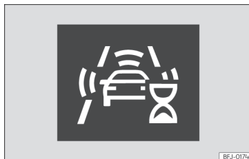
Obr. 109 Na displeji sdružených přístrojů: signalizace první automatické kalibrace systému.
