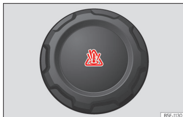
Obr. 180 Přední prostor: uzávěr vyrovnávací nádobky chladicí kapaliny.
