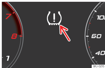
Obr. 199 Sdružené přístroje: výstraha pro ztrátu tlaku v pneumatice.
