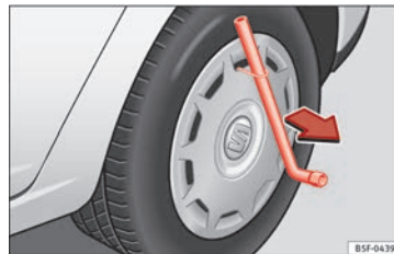
Obr. 59 Sejměte kryt kola z kola.
