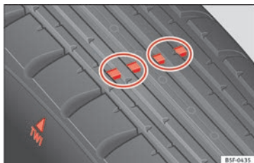
Obr. 213 Vzorek pneumatiky s ukazatelem opotřebení.
