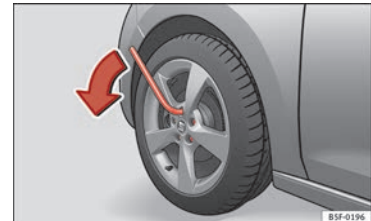
Obr. 62 Výměna kola: Povolení šroubů kol
