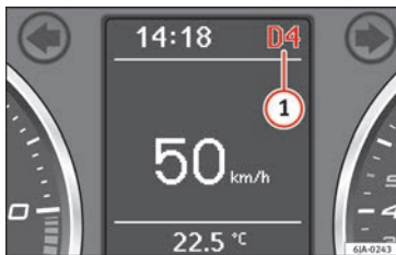
Obr. 178 Informační displej: Polohy volicí páky.
