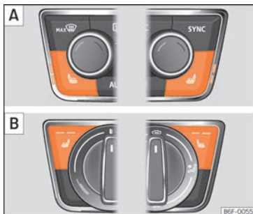
Ob. 149 Ve středové konzole: Ovladač vyhřívání předních sedadel. [A]: verze s Climatronic. [B]: verze s ruční klimatizací.
