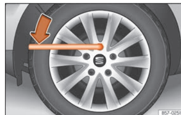
Obr. 72 Výměna kola: Povolení šroubů kol
