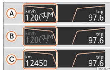
Obr. 226 Na displeji panelu přístrojů: zobrazení stavu omezovače rychlosti.
