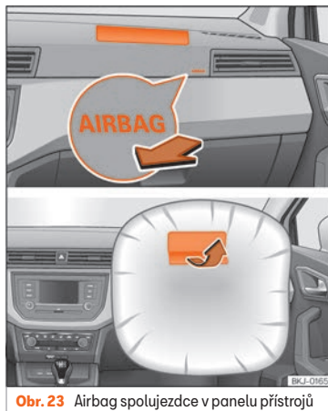
Obr. 23 Airbag spolujezdce v panelu přístrojů
