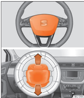
Obr. 22 Místo montáže airbagu řidiče: ve volantu.
