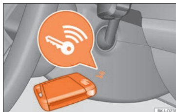
Obr. 216 Vpravo na sloupku řízení: Nouzový start.
