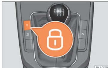
Obr. 5 Středová konzole: tlačítko centrálního zamykání dveří.
