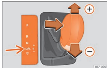
Obr. 220 Středová konzole: změna na Tiptronic.
