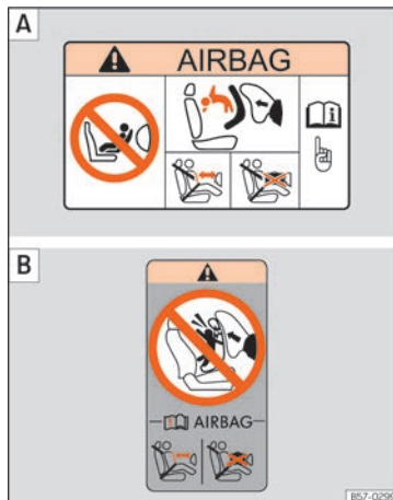
Obr. 30 Samolepka airbagu - verze 1: na sluneční cloně spolujezdce A a na zadním rámu dveří spolujezdce B .
