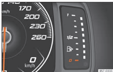
Obr. 122 Volně konfigurovatelný panel přístrojů: ukazatel zásoby paliva.
