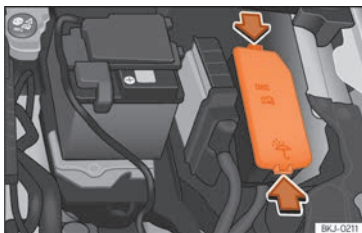
Obr. 64 V motorovém prostoru: kryt pojistkové skříňky.
