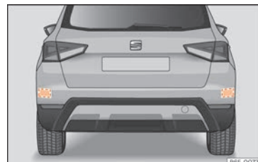
Obr. 242 Oblast za vozidlem: Oblasti radarových snímačů.
