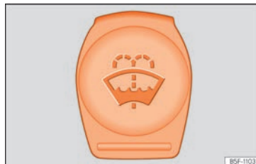
Obr. 62 V motorovém prostoru: uzávěr nádržky kapaliny do ostřikovačů.
