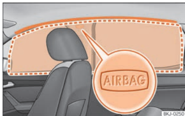
Obr. 28 Umístění a oblast nafouknutí hlavového airbagu.
