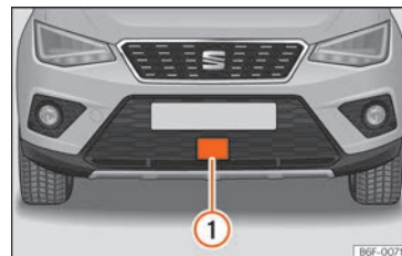
Obr. 235 V předním nárazníku: radarový snímač.
