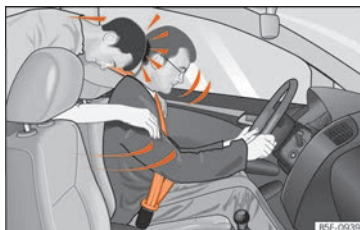
Obr. 91 Nepřipoutaný cestující na zadním sedadle je vymrštěn dopředu na připoutaného řidiče.
