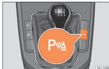
Obr. 254 Středová konzole: Tlačítko parkovacího asistenta (dle provedení).
