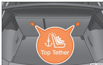
Obr. 38 Poloha ok Top Tether v zadní části zadního sedadla
