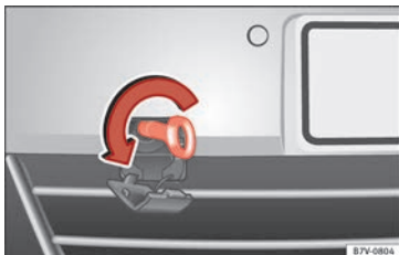
Obr. 104 Přední nárazník vpravo: našroubování vlečného oka.
