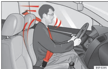
Obr. 85 Zachycení správně připoutaného řidiče bezpečnostním pásem během prudkého zabrzdění.
