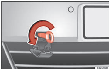
Obr. 73 Přední nárazník vpravo: našroubování vlečného oka.
