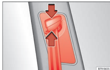
Obr. 91 U předních sedadel: nastavení výšky pásu
