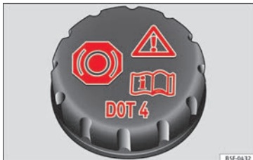
Obr. 245 V motorovém prostoru: uzávěr nádržky brzdové kapaliny
