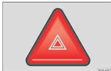
Obr. 140 Detail přístrojové desky: Spínač výstražných světel
