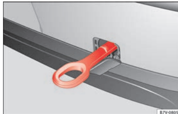
Obr. 74 Zadní nárazník vpravo: zašroubované vlečné oko.
