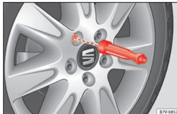
Obr. 72 Výměna kola: našroubování šroubů kol rukojetí šroubováku.
