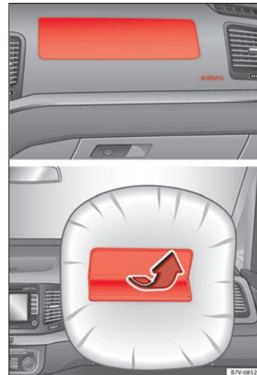
Obr. 27 Montážní poloha a oblast účinnosti čelního airbagu spolujezdce
