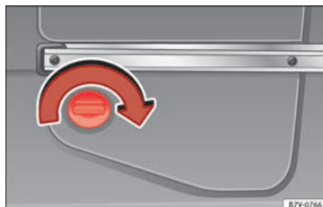
Obr. 235 V zadní části zavazadlového prostoru vlevo: nádržka pro AdBlue za krytem.
