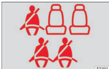
Obr. 84 Příklad pro zobrazení stavu bezpečnostního pásu na zadních sedadlech (zde u 7místné verze) v panelu přístrojů: nahore druhá řada sedadel, dole třetí řada sedadel.
