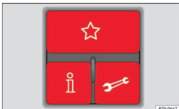
Obr. 123 Třítlačítkový modul ve stropním čalounění: Ovládací prvky systému řízení telefonu.
