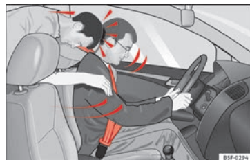
Obr. 87 Nepřipoutaný cestující na zadním sedadle je vržen dopředu na připoutaného řidiče.
