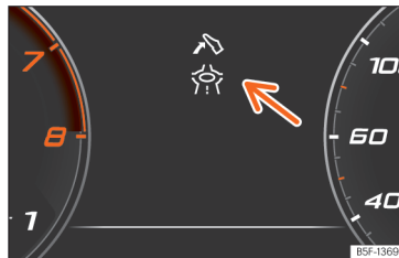
Obr. 100 Signalizace asistenta pro ekologický způsob jízdy (schématické znázornění).
