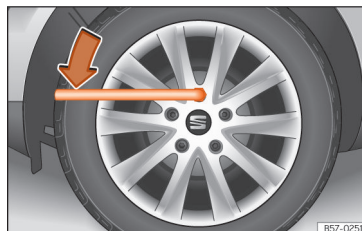
Obr. 195 Výměna kola: povolení šroubů kola
