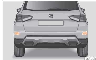
Obr. 95 Oblast za vozidlem: oblasti radarových snímačů.
