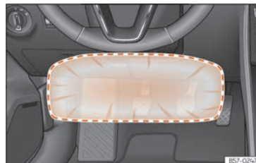
Obr. 31 Na straně řidiče: oblast účinnosti kolenního airbagu.
