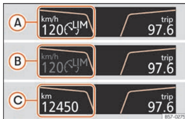
Obr. 251 Na displeji panelu přístrojů: zobrazení stavu omezovače rychlosti.
