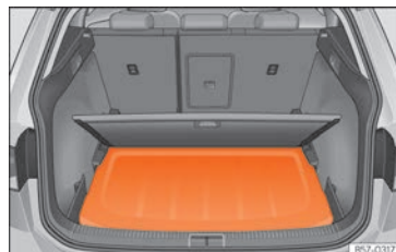
Obr. 173 V zavazadlovém prostoru: Vložení krytu zavazadlového prostoru.
