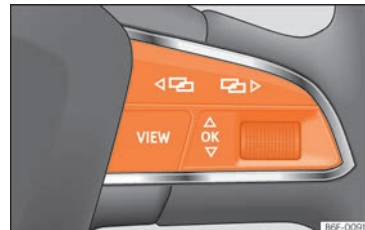
Obr. 133 Prává strana multifunkčního volantu: ovládací prvky pro menu a zobrazení informací v panelu přístrojů.
