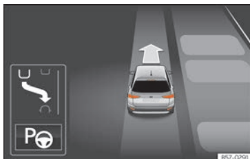
Obr. 281 Na displeji panelu přístrojů: Zobrazení parkovacího asistenta s omezenou viditelností.
