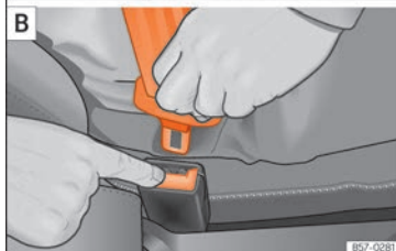
Obr. 21 Jazýček spony bezpečnostního pásu zasuňte do zámku a uvolněte ze zámku.
