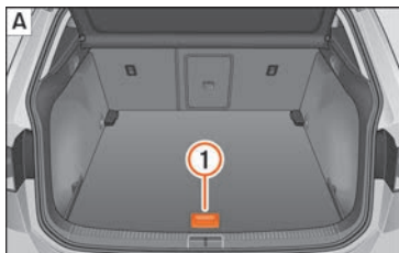
Obr. 181 Variabilní podlaha zavazadlového prostoru: sklopená poloha.
