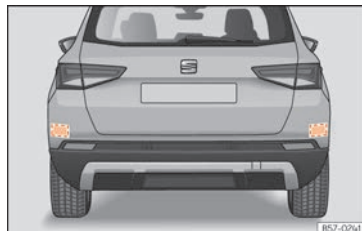
Obr. 272 Oblast za vozidlem: Oblasti radarových snímačů.
