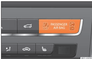
Obr. 99 Přístrojová deska: kontrolka deaktivovaného airbagu spolujezdce.
