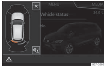
Obr. 287 Miniaturní signalizace automatického zapnutí
