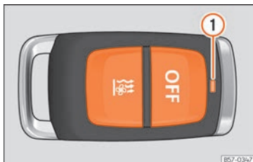
Obr. 187 Nezávislé topení: s rádiovým dálkovým ovládním
