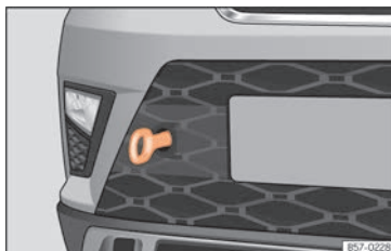
Obr. 80 Přední nárazník vpravo: zašroubované vlečné oko
