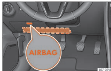
Obr. 30 Na straně řidiče: umístění kolenního airbagu.
