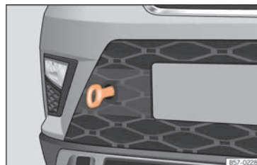
Obr. 102 Na pravé straně předního nárazníku: zašroubované vlečné oko.
