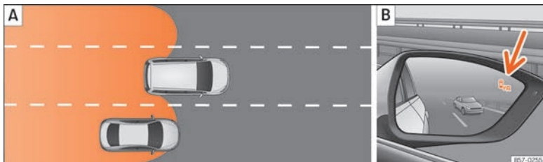
Obr. 274 Schématické zobrazení: A Předjíždění a následné zařazení do pravého jízdního pruhu. B Zobrazení asistenta Blind-Spot ve vnějším zrcátku vpravo.
