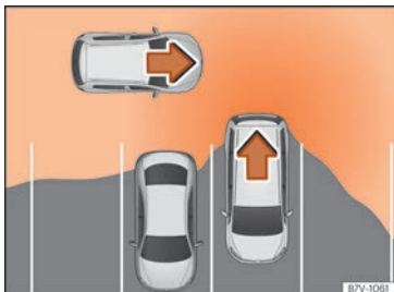
Obr. 275 Schematické zobrazení asistenta pro vyparkování: kontrolovaná oblast kolem vyjíždějícího vozidla.
