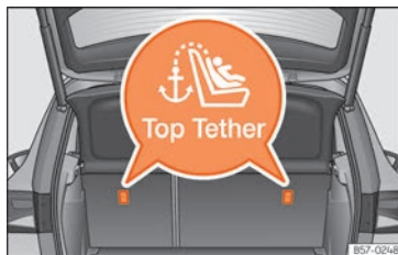
Obr. 40 Poloha ok Top Tether v zadní části zadního sedadla
