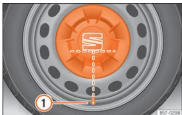
Obr. 74 Správné umístění celoplošného krytu kola u ocelových disků.
