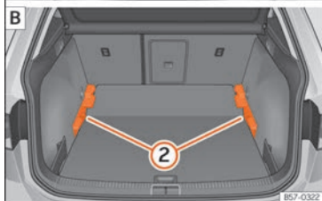
Obr. 180 Variabilní podlaha zavazadlového prostoru: A vysoká poloha; B nízká poloha.
