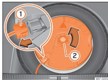
Obr. 311 V zavazadlovém prostoru: demontáž subwooferu.
