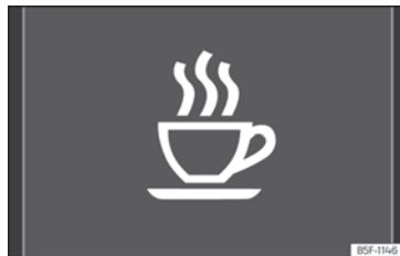
Obr. 126 Na displeji panelu přístrojů: Symbol rozpoznání únavy.
