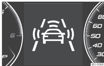
Obr. 257 Na displeji panelu přístrojů: Zobrazení předběžné výstrahy.
