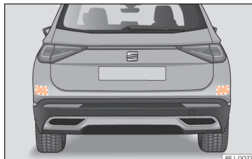
Obr. 274 Pohled na zád' vozidla: Oblasti radarových snímačů.
