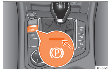
Obr. 278 Ve spodní části středové konzoly: tlačítko elektronické parkovací brzdy.
