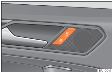
Obr. 76 Dveře řidiče: tlačítko centrálního zamykání dveří.
