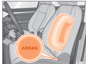
Obr. 22 Boční airbag v sedadle řidiče
