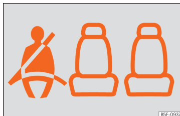
Obr. 6 Panel přístrojů: Zobrazení, že místo v zadu vlevo je obsazeno a spolucestující má připnutý bezpečnostní pás.
