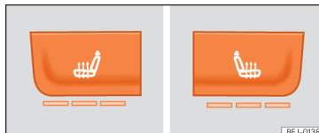
Obr. 157 Ve středové konzole: ovládací prvky vyhřívání předních sedadel.
