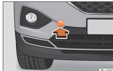
Obr. 48 Na pravé straně předního nárazníku: odstranění krytu.
