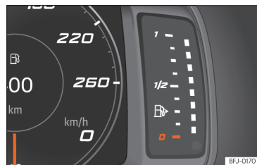
Obř. 62 Volně konfigurovatelný panel přístrojů: palivoměr
