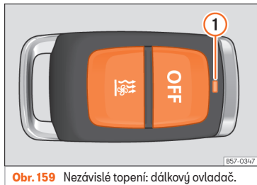
Obr. 159 Nezávislé topení: dálkový ovladač.
