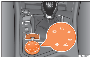
Obr. 249 Středová konzola: otočné tlačítko [Driving Experience button].
