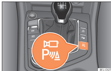
Obr. 294 Středová konzola: tlačítko k ruční aktivaci a daktivaci výhledu do okolí vozidla ve spojení s parkovacím asistentem.
