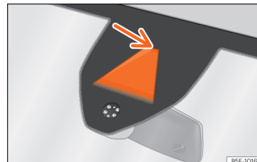
Obr. 270 Na čelním skle: Průzor kamery asistentu udržování jízdního pruhu.
