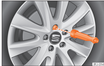
Obr. 42 Výměna kola: vyšroubujte šrouby kol rukojetí šroubováku.
