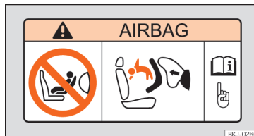
Obr. 26 Nálepka pro airbag: na sluneční cloně na straně spolujezdce
