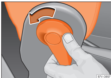
Obr. 118 Odjistění sklápěcího opěradla sedadla spolujezdce
