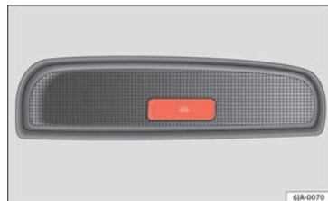
Obr. 135 Vnitřní osvětlení vozidla vzadu
