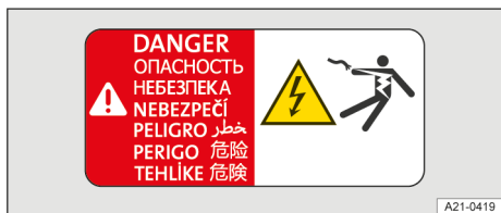
Obr. 4 Varovný štítek na vysokonapěťových součástech.
