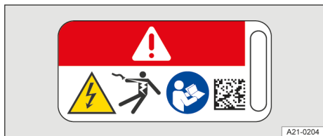
Obr. 5 Varovný štítek na vysokonapěťových součástech.
