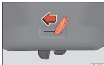
Obr. 4 IBIZA/IBIZA SC: Nouzové otevření víka zavazadlového prostoru
