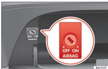
Obr. 84 V odkládací přihrádce: Spínač s klíčem pro zapnutí a odpojení airbagu spolujezdce
