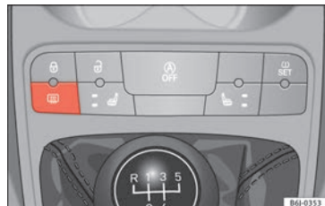
Obr. 136 Středová konzole: Spínač vyhřívání zadního skla.
