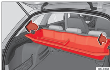
Obr. 160 Zavazadlový prostor: Demontáž odkládací přihrádky.
