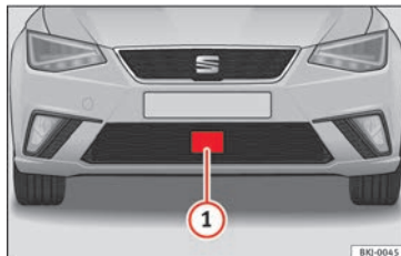
Obr. 192 V předním nárazníku: radarový senzor.
