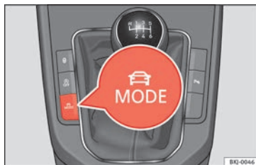
Obr. 203 Vedle řadicí páky: tlačítko MODE.
