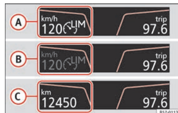
Obr. 188 Na displeji panelu přístrojů: zobrazení stavu omezovače rychlosti.
