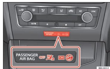
Obr. 57 Kontrolka deaktivace airbagu spolujezdce.
