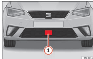
Obr. 197 V předním nárazníku: radarový senzor.
