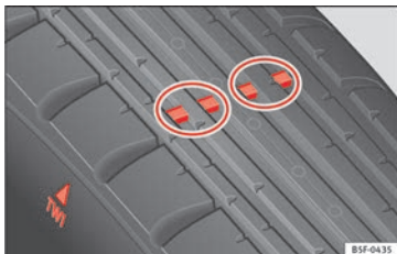
Obr. 232 Ukazatel opotřebení profilu pneumatiky
