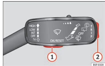
Obr. 47 Páčka stěračů skel: ovládací tlačítka.
