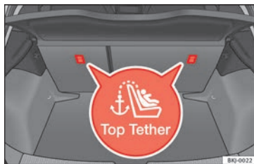
Obr. 33 Poloha ok Top Tether v zadní části zadního sedadla
