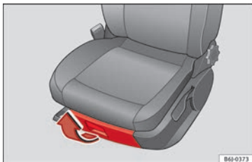
Obr. 160 Odkládací přihrádka pod pravým předním sedadlem.
