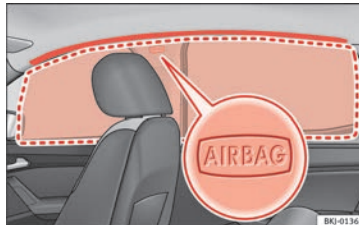
Obr. 27 Umístění a oblast nafouknutí hlavového airbagu.
