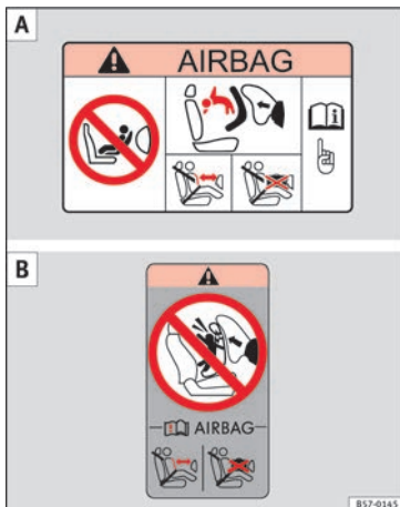
Obr. 29 Samolepka airbagu - verze 1: na sluneční cloně spolujezdce [A] a na zadním rámu dveří spolujezdce [B].
