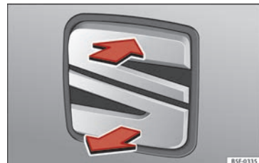
Obr. 6 Zadní výklopné dveře: otevření zvenku
