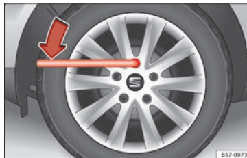
Obr. 83 Výměna kola: Povolení šroubů kol
