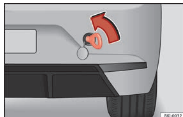
Obr. 111 Zadní nárazník vpravo: zašroubované vlečné oko
