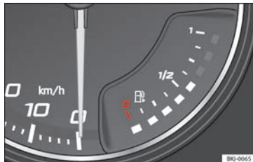
Obr. 128 Ukazatel zásoby paliva (palivoměr).
