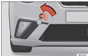
Obr. 87 Přední nárazník vpravo: Vlečné oko.
