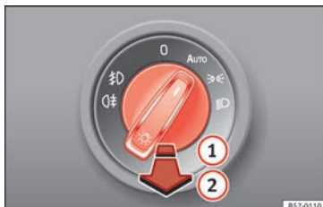
Obr. 148 Přístrojová deska: Ovládací prvek světel
