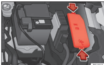
Obr. 72 V motorovém prostoru: kryt pojistkové skříňky.
