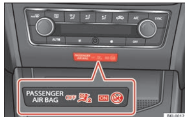
Obr. 24 Střední díl přístrojové desky: Kontrolka při odpojení airbagu spolujezdce.
