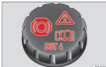
Obr. 69 Motorový prostor: uzávěr nádrčky brzdové kapaliny
