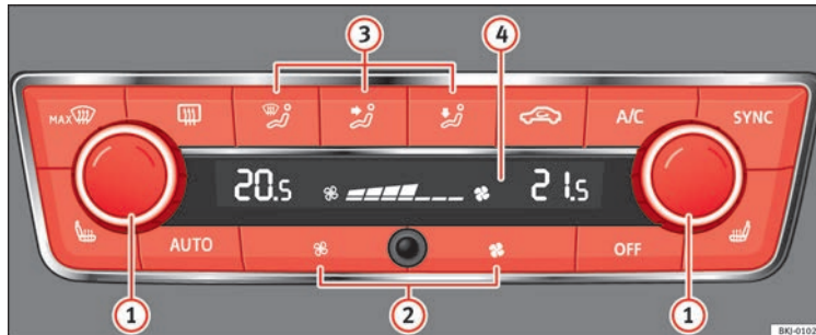
Obr. 62 Ve středové konzole: Ovládací prvky Climatronic.
