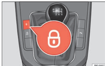
Obr. 3 Středová konzole: tlačítko centrálního zamykání dveří.
