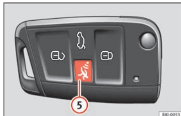
Obr. 137 Klíč od vozidla s tlačítkem alarmu.
