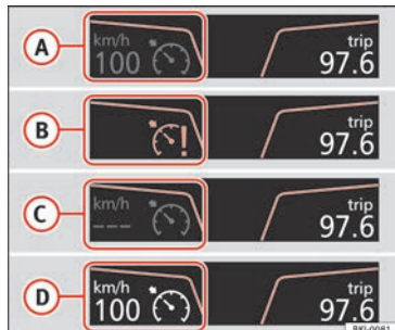
Obr. 187 Displej panelu přístrojů: ukazatele stavu tempomatu.
