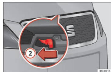
Obr. 10 Páčka pod víkem motorového prostoru.
