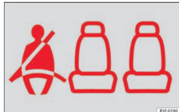
Obr. 99 Panel přístrojů: Zobrazení, že místo vzadu vpravo je obsazeno a příslušný bezpečnostní pás je připnut.
