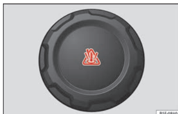
Obr. 68 Motorový prostor: uzávěr vyrovnávací nádržky chladicí kapaliny motoru
