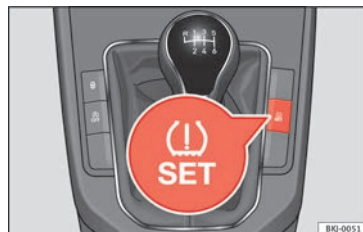
Obr. 234 Středová konzole: Tlačítko ukazatele kontroly tlaku vzduchu v pneumatikách
