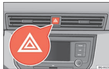
Obr. 42 Přístrojová deska: Spínač varovných světel
