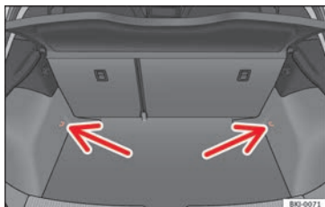
Obr. 169 Uspořádání upevňovacích ok v zavazadlovém prostoru.
