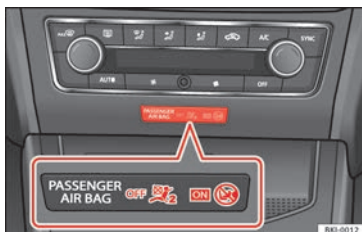
Obr. 106 Střední díl přístrojové desky: Kontrolka při odpojení airbagu spolujezdce.
