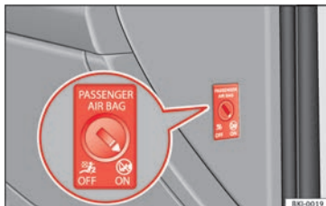
Obr. 23 Spínač čelního airbagu spolujezdce.
