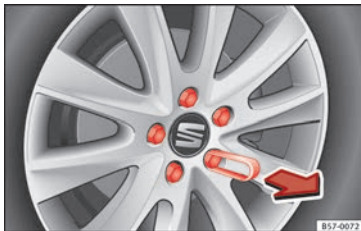
Obr. 82 Kolo: Šrouby kola s víkem.
