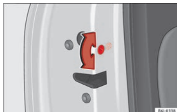
Obr. 145 Bezpečnostní dětská pojistka v levých dveřích
