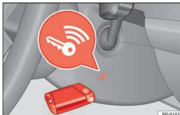
Obr. 179 Vpravo na sloupku řízení: Nouzový start.
