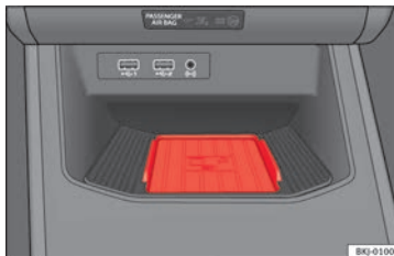
Obr. 134 Středová konzole: Connectivity Box
