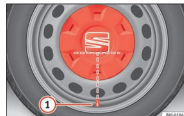
Obr. 78 Správné umístění celoplošného krytu kola u ocelových disků.
