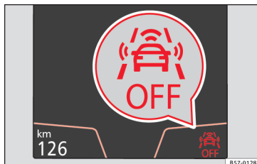
Obr. 193 Na displeji panelu přístrojů: zobrazení, že Front Assist je vypnutý.
