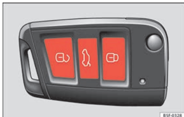
Obr. 2 Klíč s dálkovým ovládáním: tlačítka
