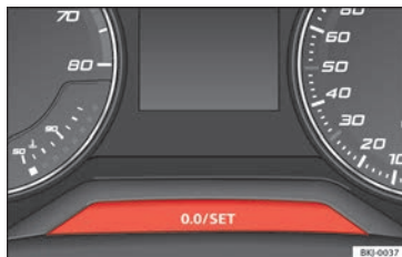
Obr. 126 Panel přístrojů: Počítadlo kilometrů a nulovací tlačítko.
