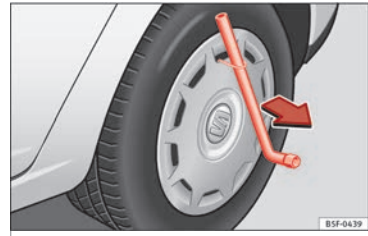
Obr. 81 Sejměte kryt kola z kola.
