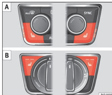
Obr. 156 Ve středové konzole: Ovladač vyhřívání předních sedadel. A: verze s Climatronic. B: verze s ruční klimatizací.
