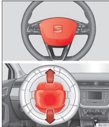
Obr. 21 Místo montáže airbagu řidiče: ve volantu.
