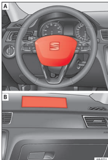
Obr. 15 Airbag řidiče ve volantu a airbag spolujezdce v přístrojové desce
