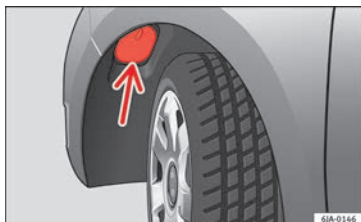
Obr. 91 Výměna žárovky tlumeného světla: Podběh kola
