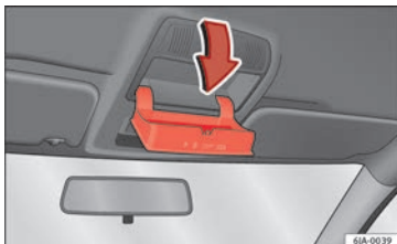
Obr. 156 Detail obložení střechy: schránka na brýle
