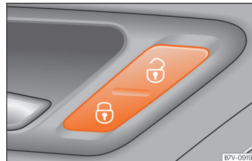
Obr. 90 Dveře řidiče: tlačítka centrálního zamykání dveří.
