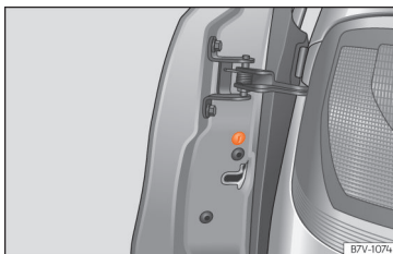
Obr. 96 V přední části posuvných dveří: gumovým těsněním zakryté nouzové odemýkání
