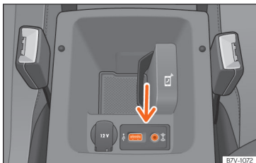
Obr. 231 Středová loketní opěrka vpředu: Přípojka USB/AUX-IN.
