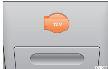
Obr. 171 Středová konzola vzadu: zásuvka 12V.
