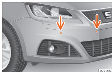
Obr. 272 Snímače kontroly parkovací vzdálenosti vpředu v nárazníku.
