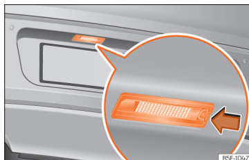
Obr. 72 V zadním nárazníku: světlo registrační značky.
