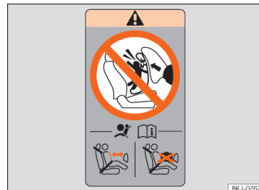
Obr. 28 Nálepka pro airbag: v zadní části rámu dveří spolujezdce
