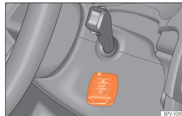
Obr. 235 Nouzové nastartování u vozidel s Keyless Access.
