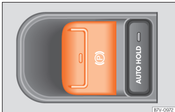
Obr. 266 Ve středové konzole: tlačítko elektronické parkovací brzdy.
