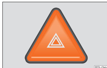
Obr. 117 Přístrojová deska: spínač výstražných světel.
