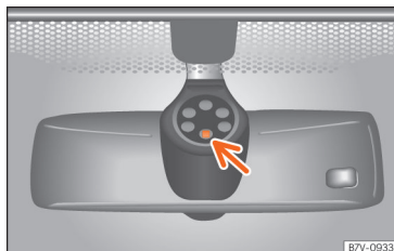
Obr. 122 Citlivá plocha snímače deště.
