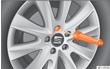
Obr. 49 Výměna kola: vyšroubujte šrouby kol rukojetí šroubováku.
