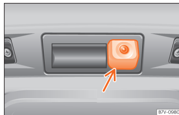
Obr. 249 V zadním nárazníku: montážní místo zpětné kamery.
