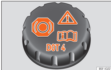
Obr. 292 Motorový prostor: uzávěr nádobky brzdové kapaliny.
