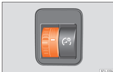
Obr. 119 Vedle volantu: ovladač osvětlení přístrojů a spínačů
