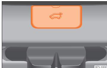
Obr. 107 Detail zavazadlového prostoru: přístup k nouzovému odemykání.
