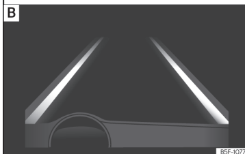
Obr. 260 Na displeji panelu přístrojů: Zobrazení na displeji asistenta udržování jízdního pruhu (příklad 1).
