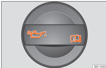
Obr. 289 Uzávěr plnicího otvoru motorového oleje
