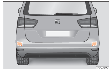
Obr. 247 Pohled na zadní vozidla: oblasti radarových snímačů.
