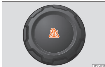
Obr. 291 Motorový prostor: uzávěr vyrovnávací nádobky chladicí kapaliny motoru.
