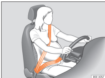
Obr. 13 Průběh popruhu bezpečnostního pásu u těhotných žen
