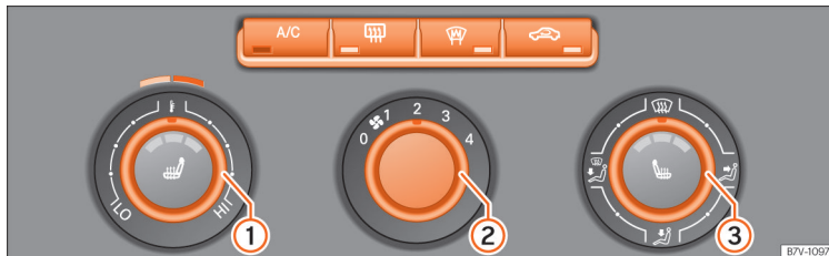
Obr. 174 Ve středové konzole: ovládací prvky klimatizace.
