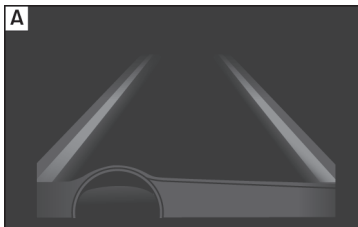
Obr. 261 Na displeji panelu přístrojů: Zobrazení na displeji asistenta udržování jízdního pruhu (příklad 2).
