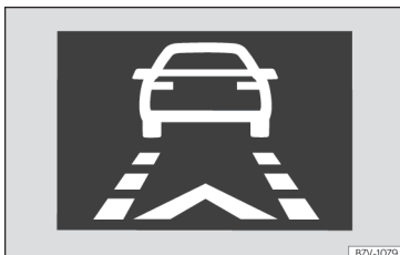
Obr. 252 Na displeji panelu přístrojů: signalizace předběžné výstrahy.
