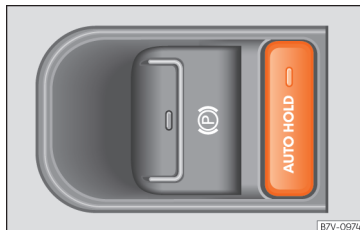
Obr. 267 Ve středové konzole: tlačítko Auto Hold
