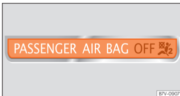
Obr. 19 Kontrolka odpojeného airbagu spolujezdce v přístrojové desce.
