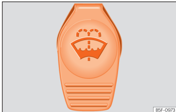
Obz. 293 V motorovém prostoru: modrý uzávěr nádrčky ostřikovací kapalin
