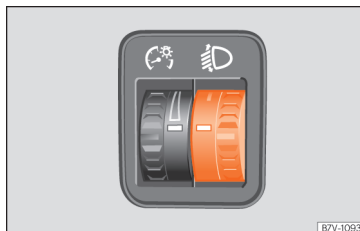
Obr. 118 Vedle volantu: ovladač regulace dosahu světel
