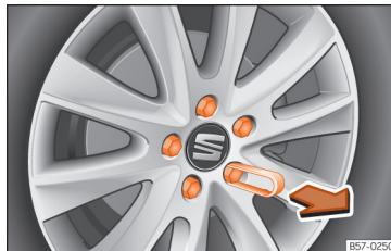
Obr. 43 Kolo: Šrouby kola s víkem.
