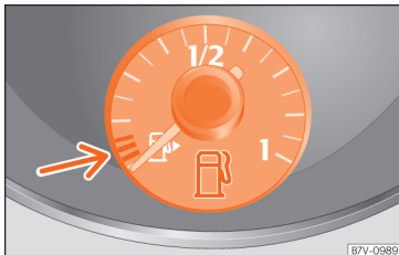
Obr. 78 V panelu přístrojů: palivoměr
