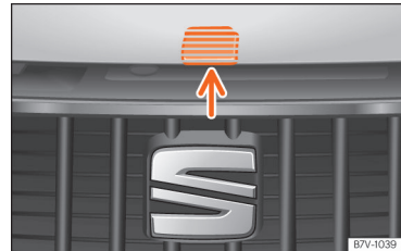
Obr. 284 Páčka pod víkem motorového prostoru.
