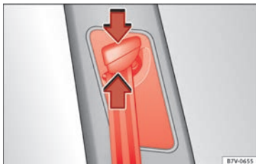
Obr. 89 U předních sedadel: nastavení výšky pásu
