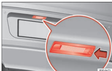
Obr. 114 Zadní nárazník: Osvětlení státní poznávací značky.
