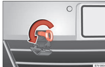
Obr. 71 Přední nárazník vpravo: našroubování vlečného oka.
