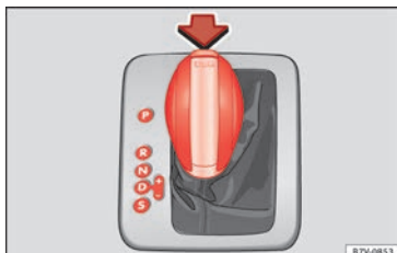
Obr. 48 Automatická převodovka: Polohy volicí páky.
