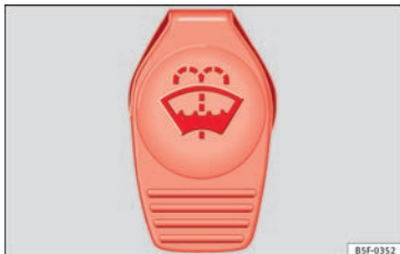
Obr. 248 V motorovém prostoru: uzávěr nádržky kapaliny do ostřikovačů.
