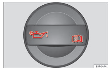
Obr. 54 Víko otvoru pro plnicí otvor motorového oleje
