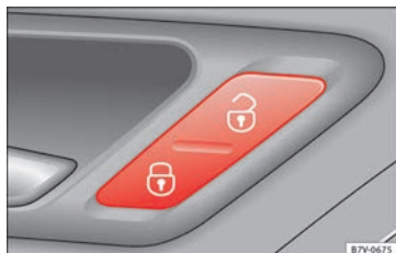
Obr. 129 U dveří řidiče: tlačítko centrálního zamykání dveří.
