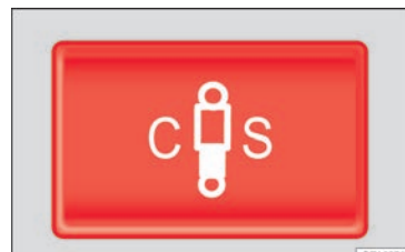
Obr. 228 Ve středové konzole: tlačítko pro nastavení adaptivní regulace podvozku.
