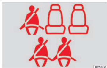
Obr. 82 Příklad pro zobrazení stavu bezpečnostního pásu na zadních sedadlech (zde u 7místné verze) v panelu přístrojů: nahore druhá řada sedadel, dole třetí řada sedadel.
