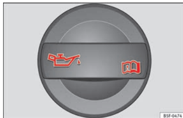
Obr. 243 V motorovém prostoru: víko plnicího otvoru motorového oleje.
