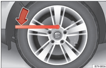
Obr. 66 Výměna kola: povolte šrouby kol.
