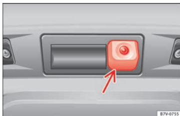
Obr. 214 V zadních výklopných dveřích: umístění kamery asistenta pro zpětnou jízdu.
