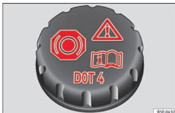
Obr. 56 Motorový prostor: uzávěr nádrčky brzdové kapaliny
