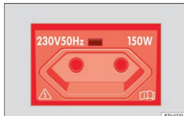
Obr. 193 Detail zadní středové konzole: eurozásuvka 230 V.
