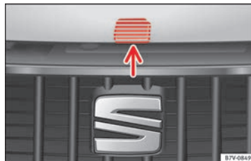
Obr. 240 Odjišťovací páčka pro otevření víka motorového prostoru v mřížce chladiče
