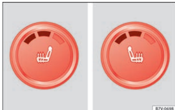
Obr. 153 Detail středové konzole: ovladače vyhřívání předních sedadel, zde při nastaveném druhém stupni vyhřívání
