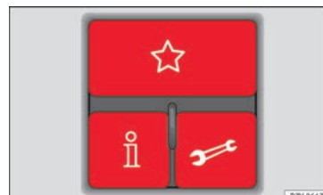
Obr. 122 Třítlačítkový modul ve stropním čalounění: Ovládací prvky systému řízení telefonu.
