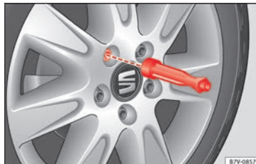
Obr. 70 Výměna kola: našroubování šroubů kol rukojetí šroubováku.
