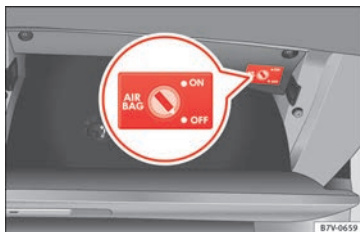
Obr. 27 V odkládací přihrádce na straně spolujezdce: klíčový přepínač k vypnutí a zapnutí čelního airbagu na straně spolujezdce.
