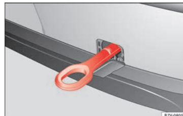
Obr. 72 Zadní nárazník vpravo: zašroubované vlečné oko.
