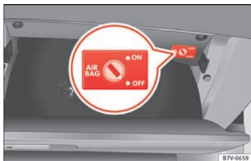
Obr. 91 V odkládací přihrádce na straně spolujezdce: klíkový přepínač k vypnutí a zapnutí čelního airbagu na straně spolujezdce.
