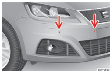
Obr. 208 Snímače kontroly vzdálenosti při parkování vpředu v nárazníku
