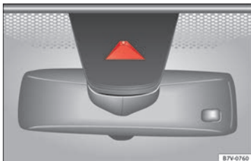
Obr. 219 Na čelním skle: Kamerový nahlížeč otvor asistenta pro udržení jízdního pruhu.
