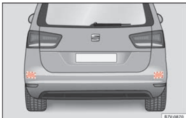
Obr. 222 Oblast za vozidlem: Oblasti radarových snímačů.
