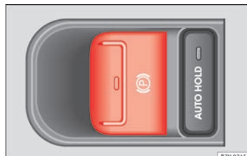
Obr. 200 Na středové konzole: spínač elektronické parkovací brzdy.
