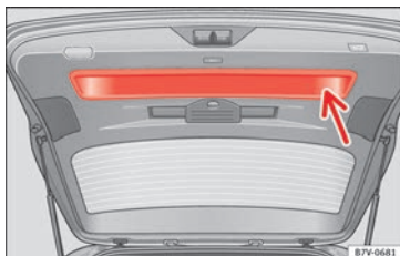
Obr. 136 Otevřené zadní výklopné dveře (zadní víko): zapuštěné madlo pro zavírání zavazadlového prostoru
