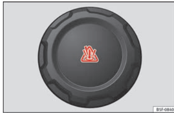
Obr. 55 Motorový prostor: uzávěr vyrovnávací nádržky chladicí kapaliny motoru
