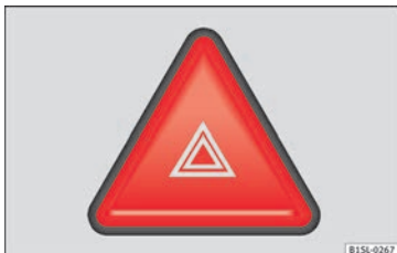
Obr. 139 Detail přístrojové desky: Spínač varovných světel
