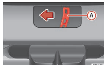
Obr. 9 Ze zavazadlového prostoru: nouzově odemkněte zadní výklopné dveře (zadní víko).
