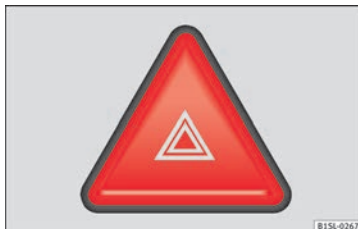
Obr. 42 Přístrojová deska: Spínač varovných světel
