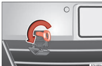
Obr. 102 Přední nárazník vpravo: našroubování vlečného oka.
