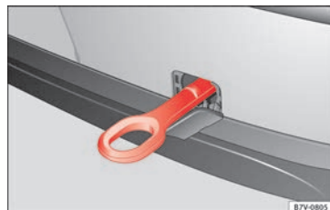
Obr. 103 Zadní nárazník vpravo: zašroubované vlečné oko.
