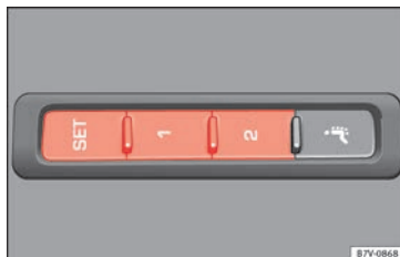
Obr. 156 Paměťová tlačítka na vnější straně sedadla řidiče
