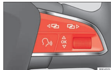
Obr. 45 Multifunkční volant: tlačítka k ovládání nabídek ve sdružených přístrojích
