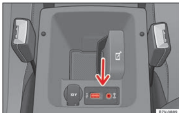
Obr. 120 Středová loketní opěrka vpředu: Přípojka USB/AUX-IN.
