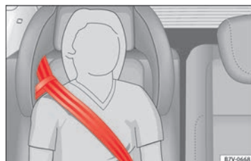
Obr. 95 Integrovaná dětská sedačka: průběh pásu s vodící třmenem
