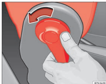
Obr. 159 Odjištění sklápěcího opěradla sedadla spolujezdce
