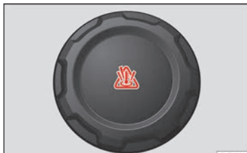
Obr. 246 V motorovém prostoru: Víko vyrovnávací nádržky chladicí kapaliny.
