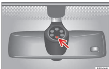
Obr. 144 Citlivá plocha dešťového snímače.
