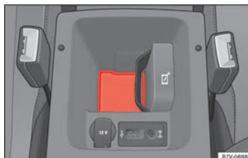
Obr. 121 Středová opěrka vpředu: uchyacení pro spojení mobilního telefonu s vnější anténou vozidla.
