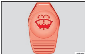
Obr. 57 V motorovém prostoru: uzávěr nádrčky kapaliny do ostřikovačů.
