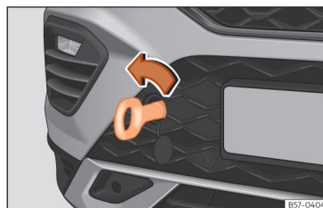
Obr. 193 Přední nárazník vpravo: zašroubované vlečné oko
